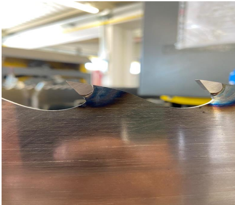
Slika 21. Pravilno izbrušena pila [8]
