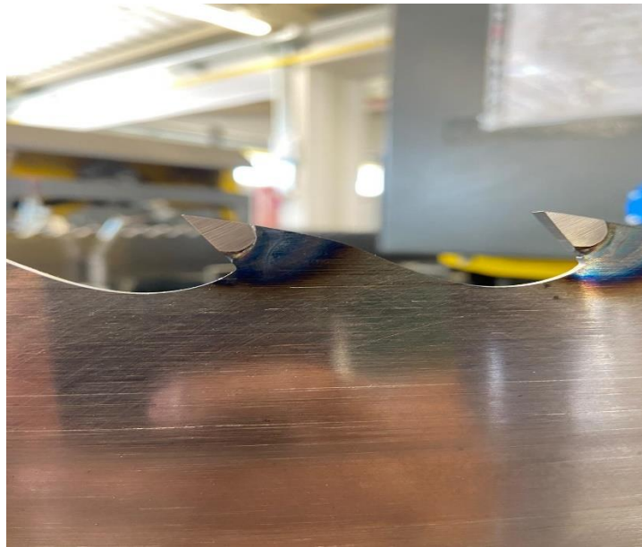
Slika 12. Zub s vrhom od stelita [8]
