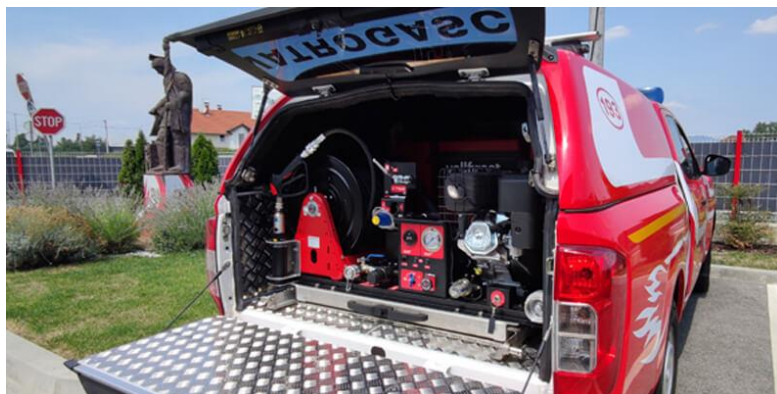
Slika 17. Visokotlačni modul ugrađen u vozilo (Izvor: https://vatropromet.hr/ ) [26]
