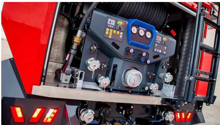
Slika 10. Pumpa ugrađena u vatrogasno vozilo (Izvor: https://www.everythingforthatmoment.com/ ) [19]
