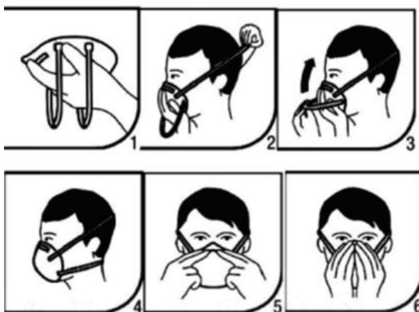
Slika 19. Prikaz pravilnog postavljanja filterske polumaske (respirator)
