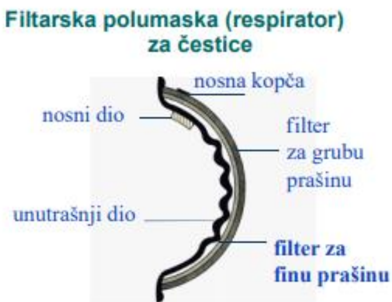
Slika 18. Prikaz višeslojnosti respiratora
