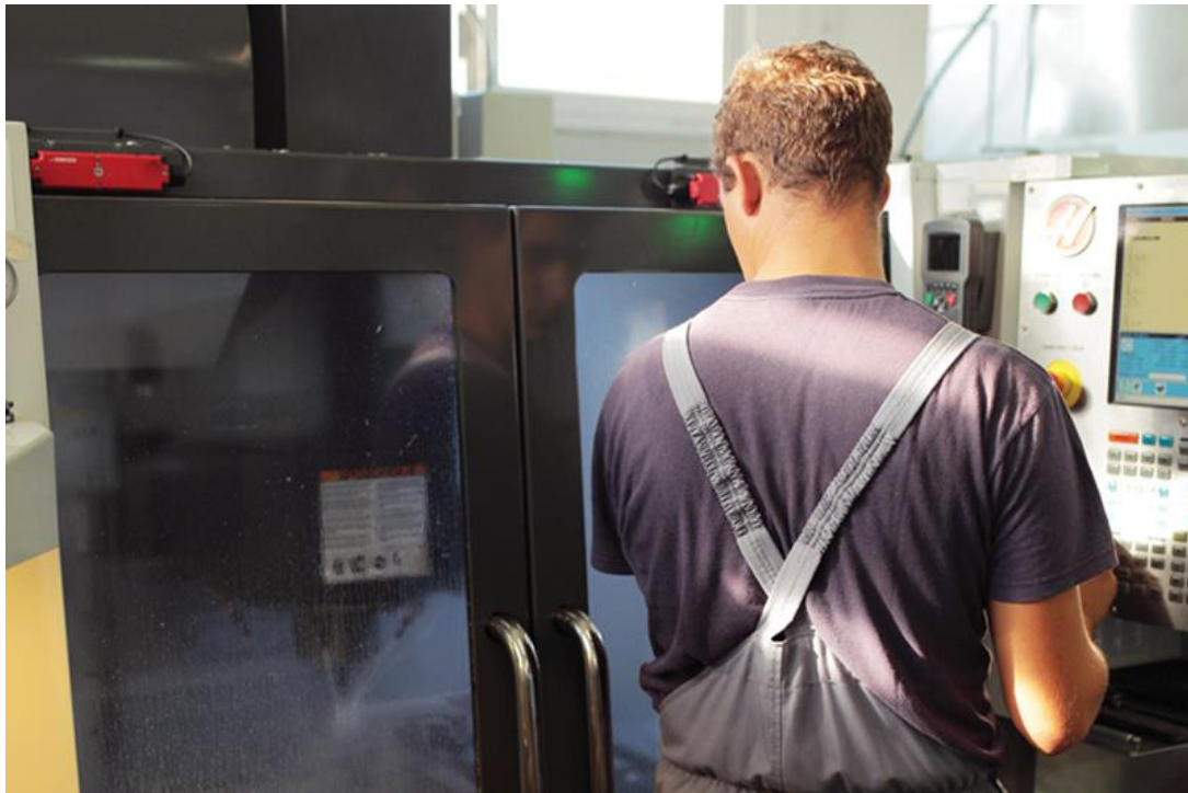
Slika 8. Zatvorena sigurnosna vrata s kaljenim staklom prilikom obrade. [4]
