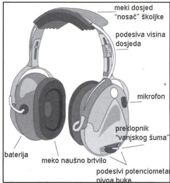
Slika 21. Presjek ušnog štitnika
