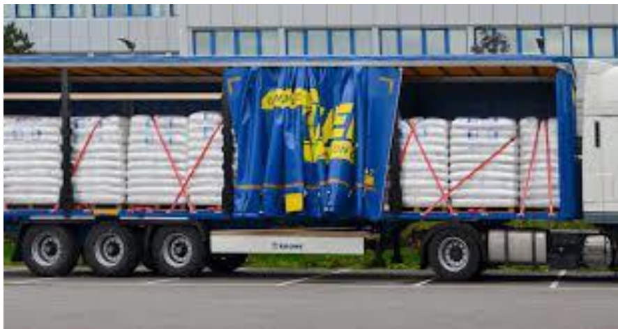
Slika 14. Primjer učvršćivanja i osiguranja tereta.,[30]
