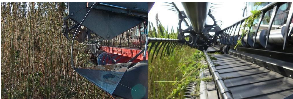
Slika 19. Uobičajeni uređaj za žetvu s pužnim transporterom (slika lijevo) i uređaj s trakastim transporterom (desno).,[35]
