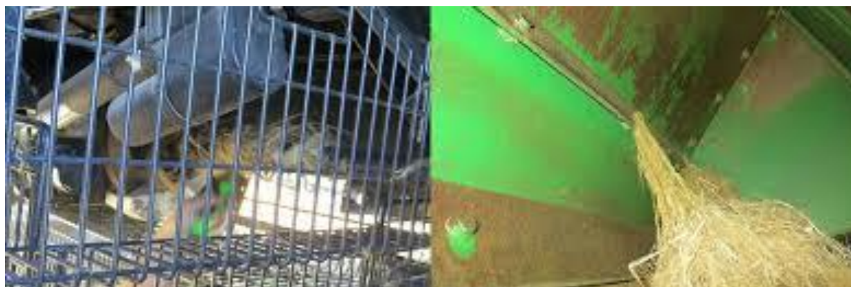
Slika 23. Metalna mreža nije spriječila zaplitanje o vratilo (lijevo) i zapletena konoplja o glavu vijka (desno).,[35]
