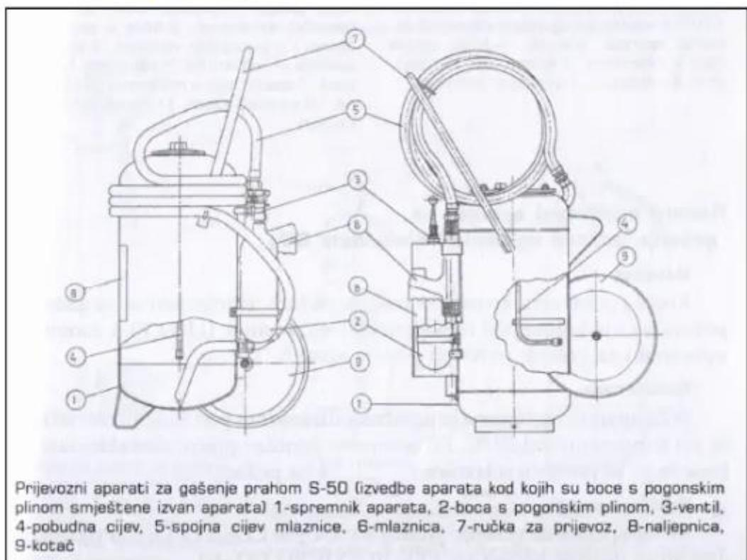
Slika 6. Aparati za gašenje požara prahom S50
