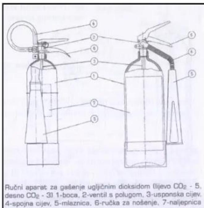
Slika 7. Aparati za gašenje ugljičnim dioksidom CO<sub>2</sub>-5
