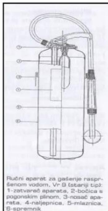
Slika 9.Ručni aparat za gašenje požara vodom i pjenom
