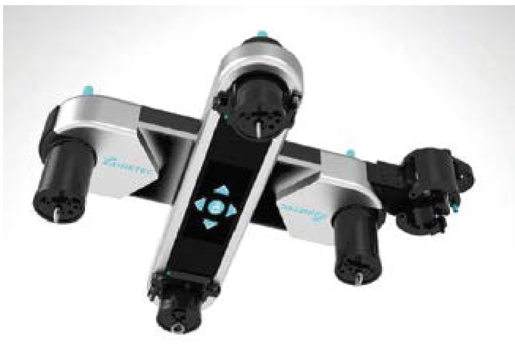
Slika 24. Robot za ispitivanje cijevi [21]
