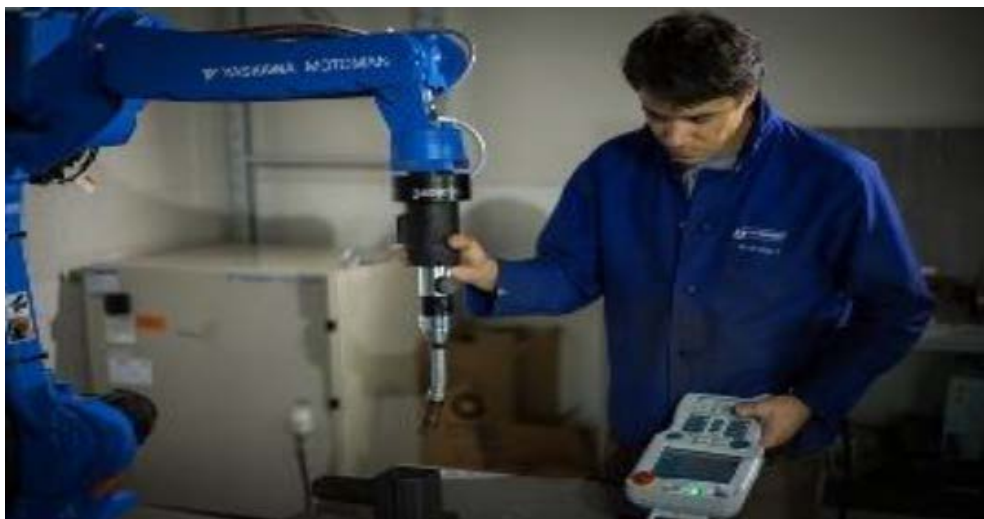
Slika 9. Ručno vođenje robota [3]
