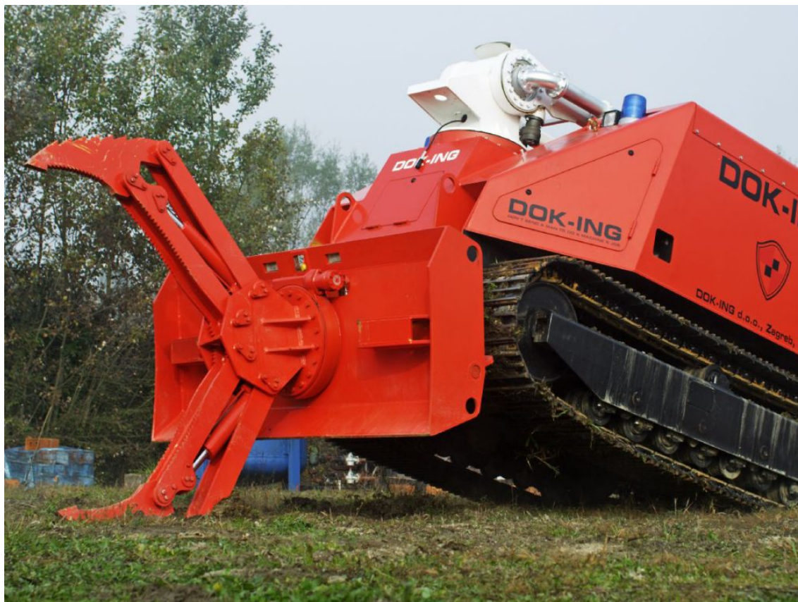
Slika 15. MVF-5 prikaz alata za zahvaćanje i guranje [14]
