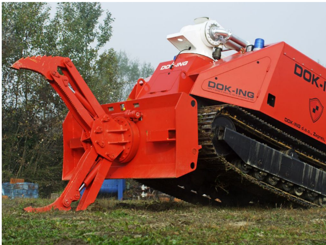
Slika 15. MVF-5 prikaz alata za zahvaćanje i guranje [14]
