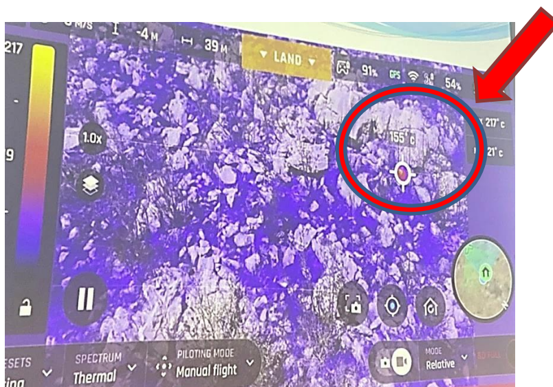
Slika 18. Snimak termalnom kamerom s sučelja upravljačke kontrole drona (Izvor: Autor rada)
