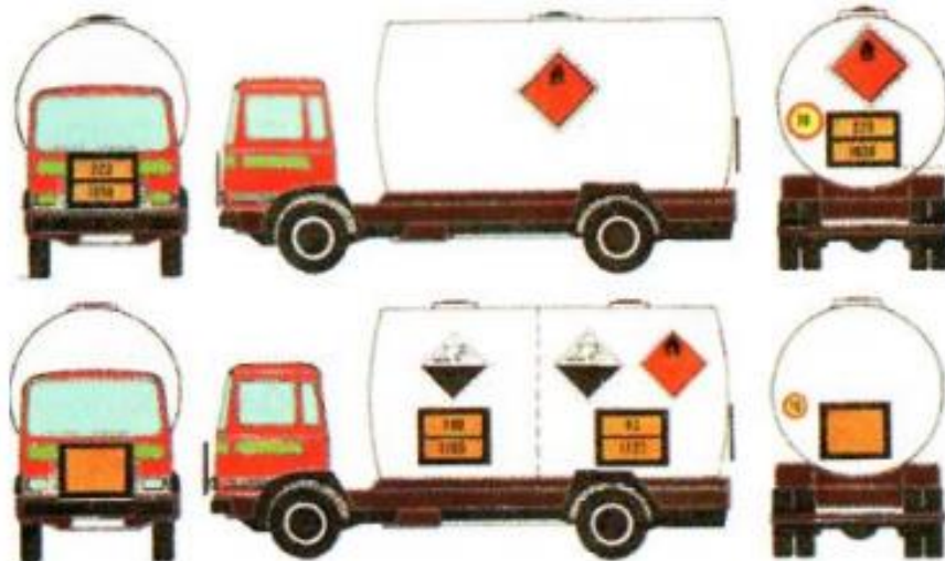
Slika 13. Označavanje vozila listicama opasnosti [2]
