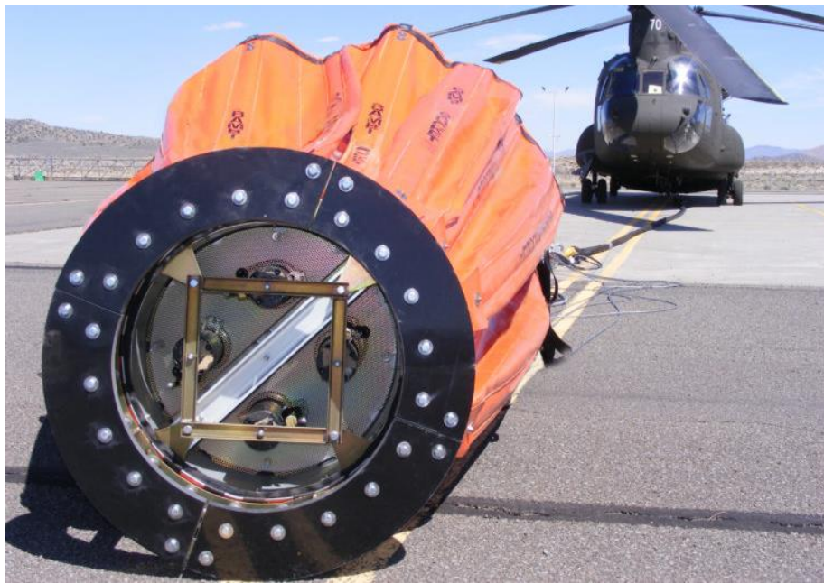
Slika 27. Zaimač Bambi Bucket sa Torrentula ventilom PowerFillom [33]
