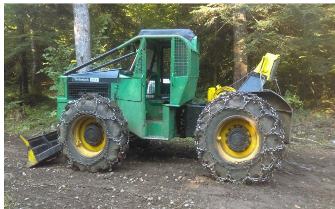
Slika [16]: Skidder sa vitlom
