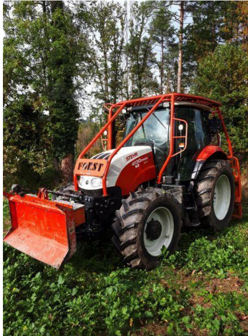
Slika [15]: Adaptirani poljoprivredni traktor
