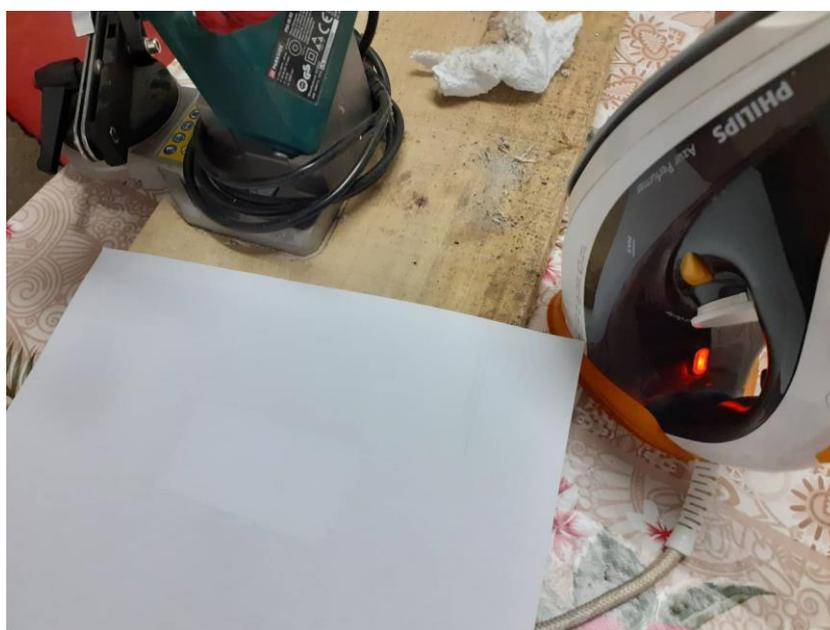
Slika 24. Predodžba glačanja predloška na bakrenu pločicu
