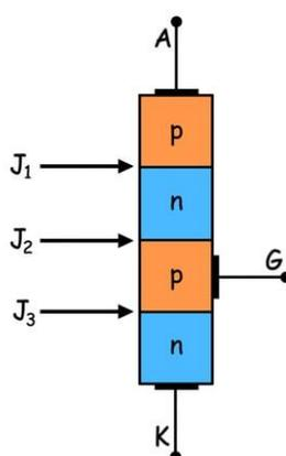
Slika 2. Predodžba prikaza SCR-a s slojevima p-n-p-n, izvor:
