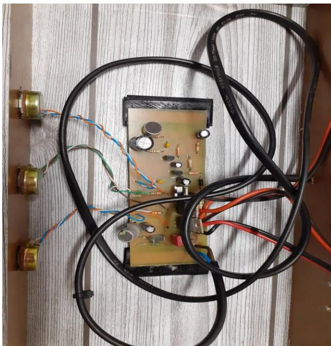
Slika 29. Predodžba postavljene pločice u kućištu
