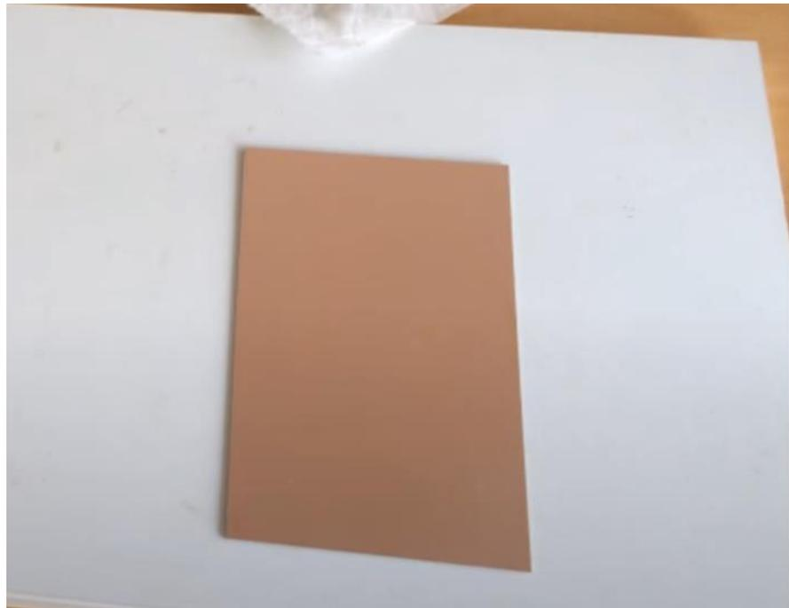
Slika 23. Predodžba izgleda pločice prije tiskanja
