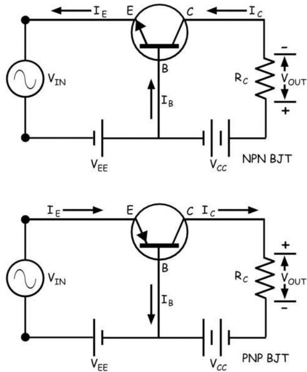
Slika 5. Predodžba PNP i NPN spoja, izvor:
