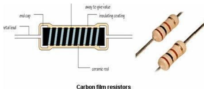
Slika 15. Predodžba otpornika i njegovih dijelova, izvor: <https://www.petvolta.com/komponente/otpornici-vrste-otpornika/>
