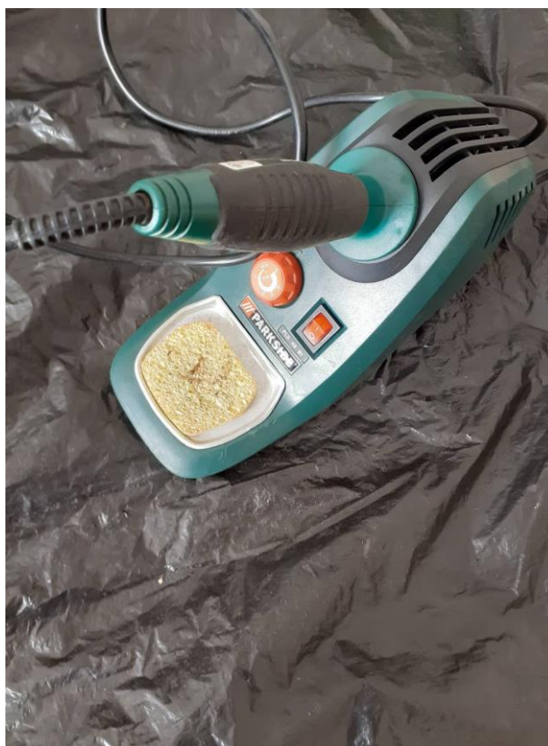
Slika 26. Predodžba lemilice za lemljenje
