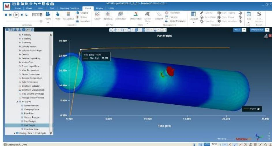
Slika 38 Rezultati simulacije djelovanja naknadnog tlaka (PACKING) (PP)
