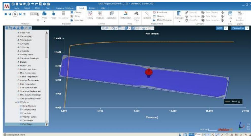
Slika 32 Rezultati simulacije djelovanja naknadnog tlaka (PACKING) (PVC)
