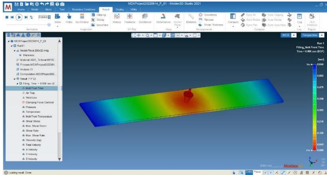
Slika 21 Rezultati simulacije utiskivanja polimerne taljevine (FILLING) (ABS)
