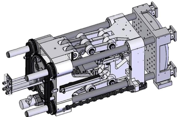
Slika 8 Prikaz sustava za zatvaranje (*clamping mechanism*) [18]
