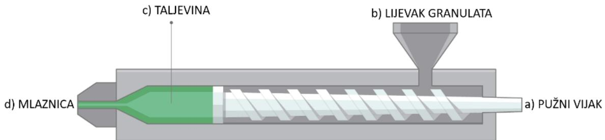
Slika 5 Cilindar, pužni vijak, lijevak granulata [14]
