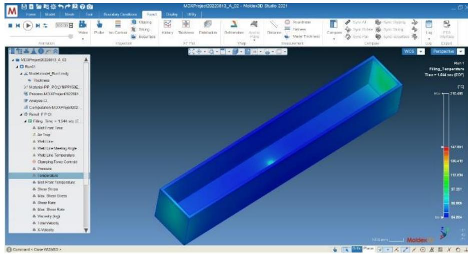
Slika 46 Rezultati simulacije utiskivanja (FILLING) (PP)
