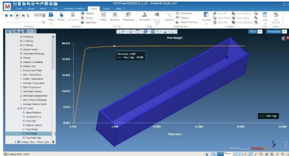
Slika 47 Rezultati simulacije djelovanja naknadnog tlaka (PACKING) (PP)
