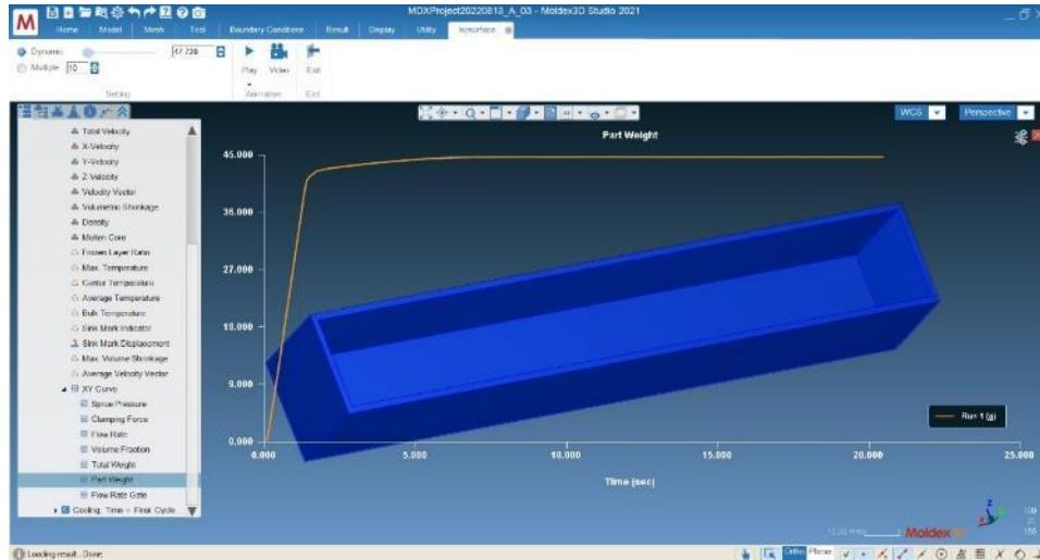
Slika 50 Rezultati simulacije naknadnog djelovanja tlaka (PACKING) (PVC)
