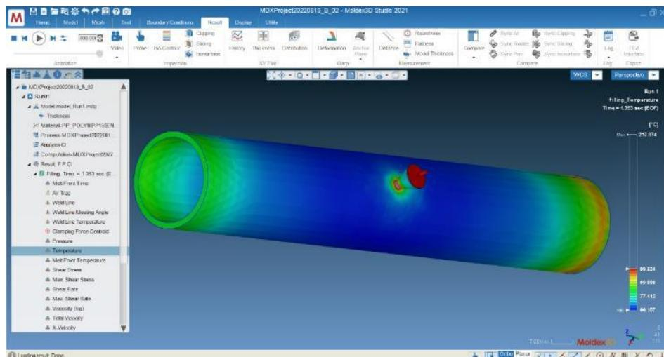
Slika 37 Rezultati simulacije utiskivanja otpreska B (FILLING) (PP)
