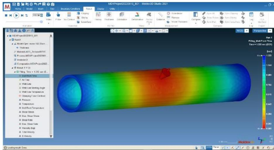
Slika 34 Rezultati simulacije utiskivanja polimerne taljevine (FILLING) (ABS)
