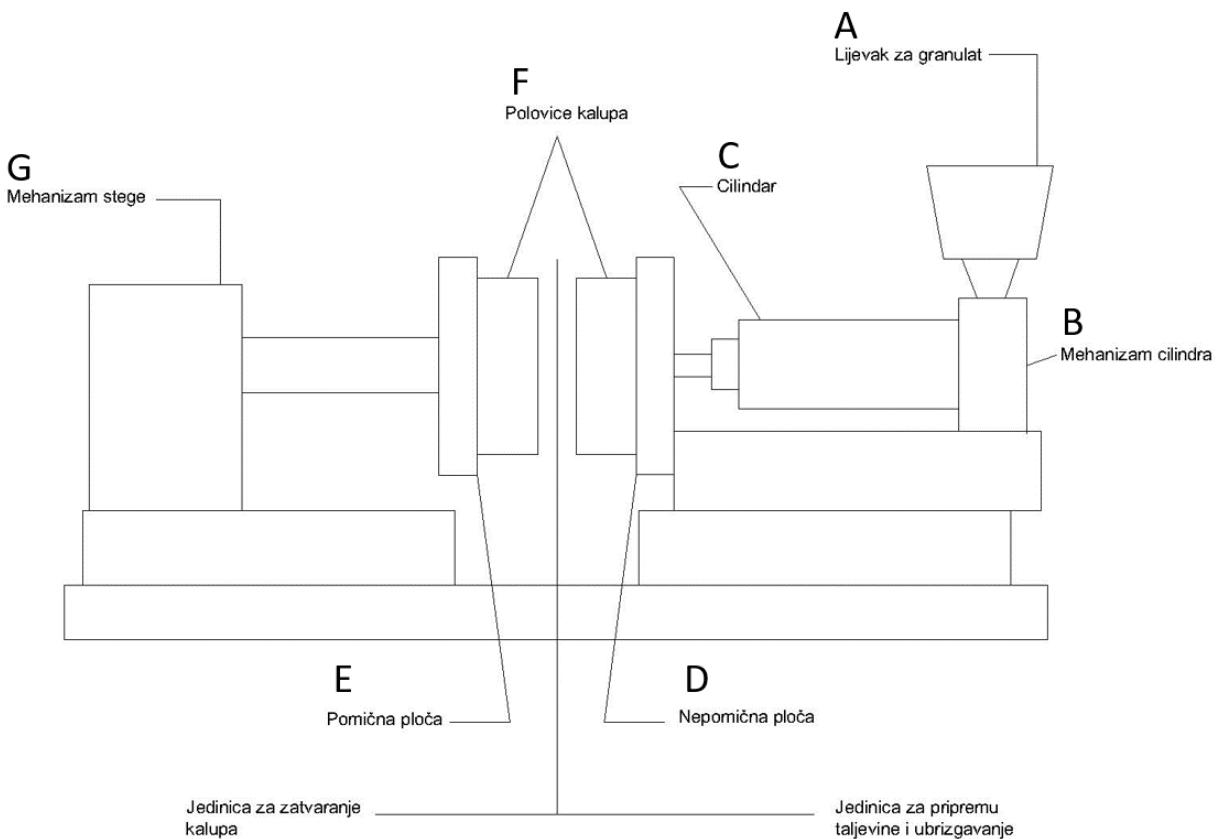
Slika 2 Osnovni dijelovi stroja za injekcijsko prešanje
