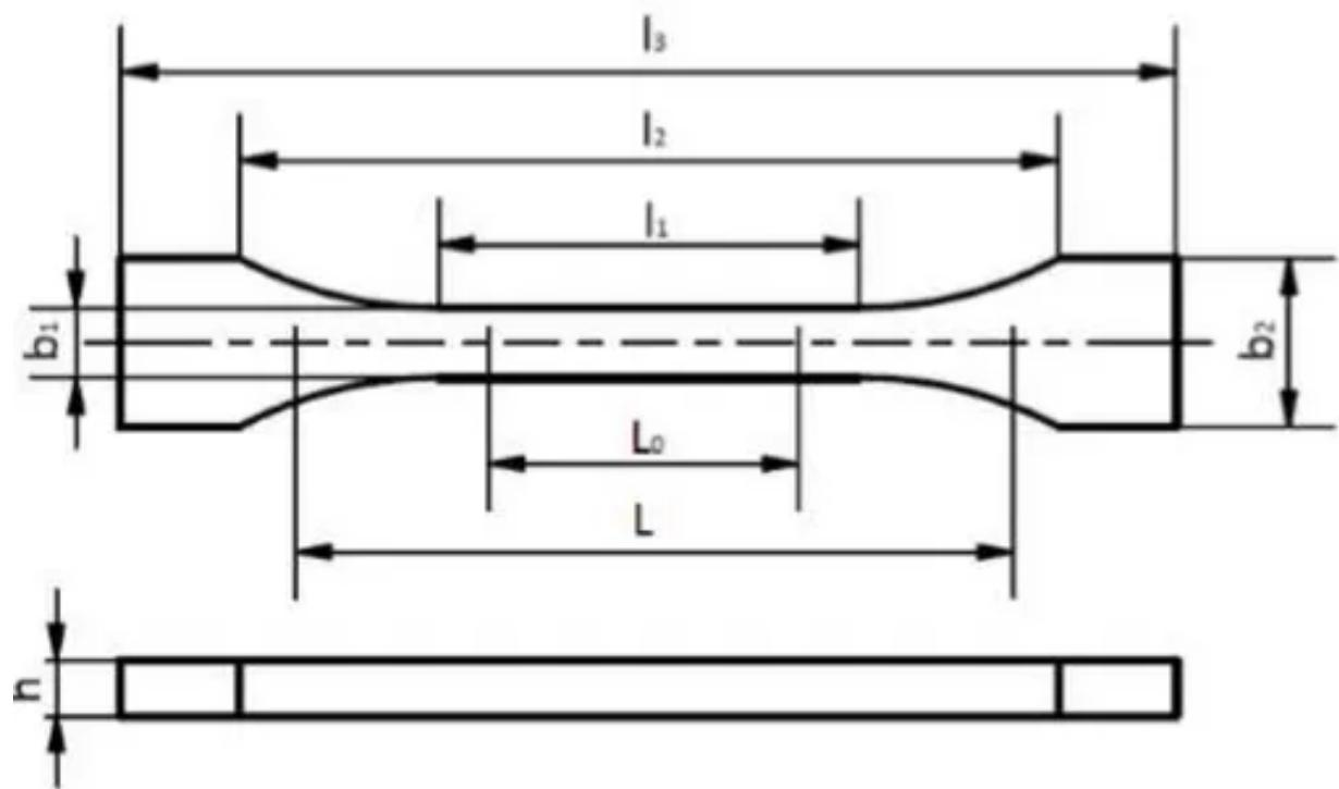
Slika 7. Prikaz ispitne epruvete četvrtastog poprečnog oblika
