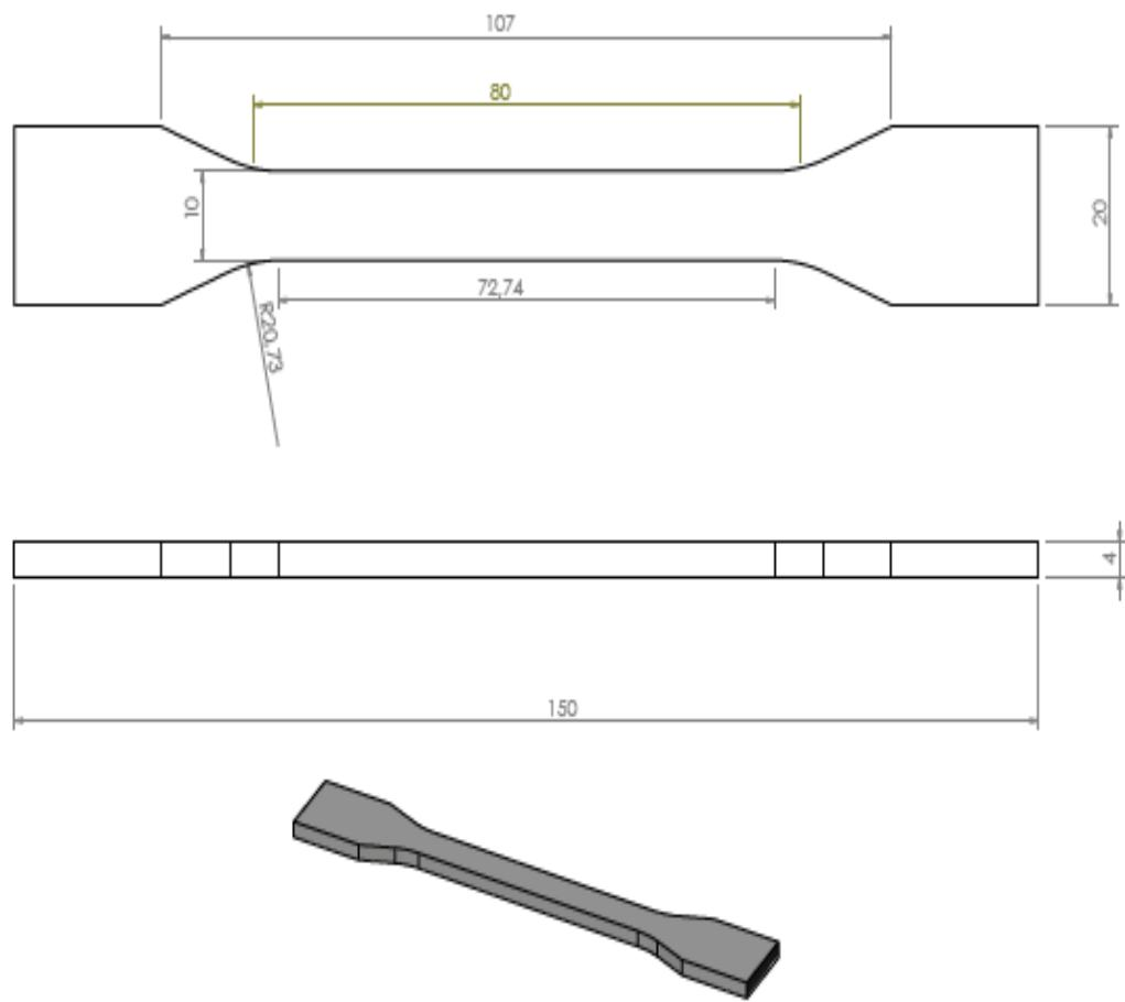
Slika 11. Prikaz ispitne epruvete
