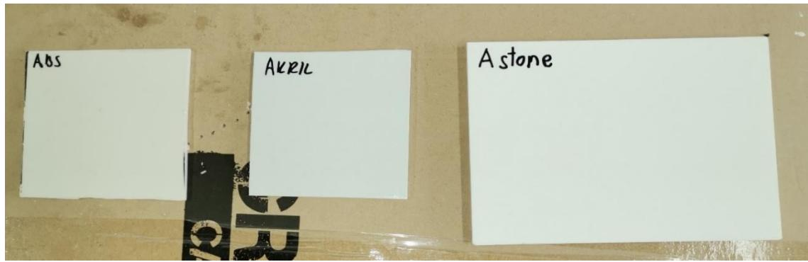
Slika 21. Prikaz ispitnih uzoraka za ispitivanje tvrdoće
