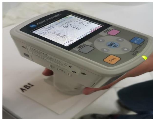
Slika 23. Mjerjenje boje kolorimetrom, ABS
