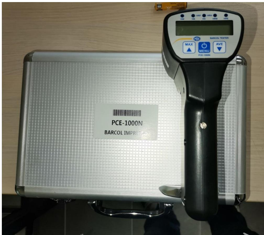
Slika 20. Barcol uređaj za ispitivanje tvrdoće
