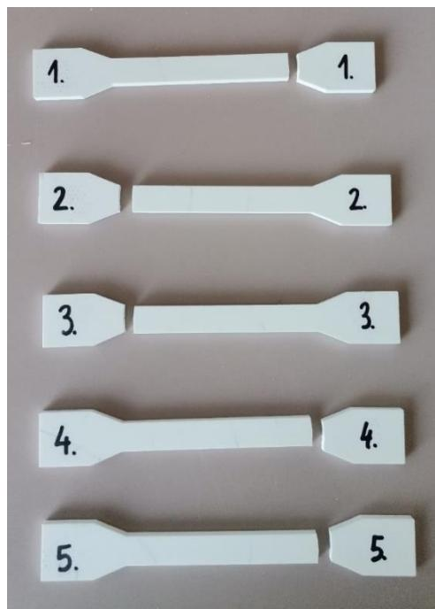
Slika 16. ASTONE poslije vlačnog ispitivanja
