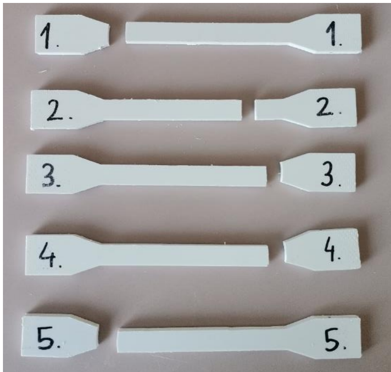
Slika 17. ABS poslije vlačnog ispitivanja
