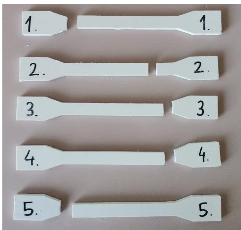
Slika 17. ABS poslije vlačnog ispitivanja
