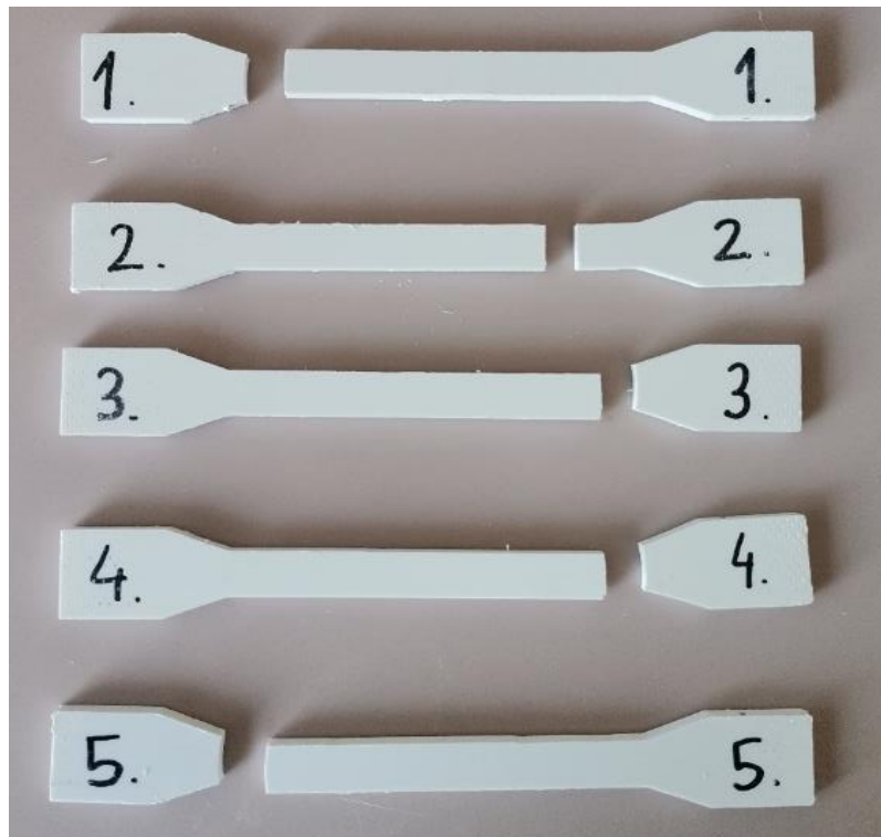
Slika 17. ABS poslije vlačnog ispitivanja
