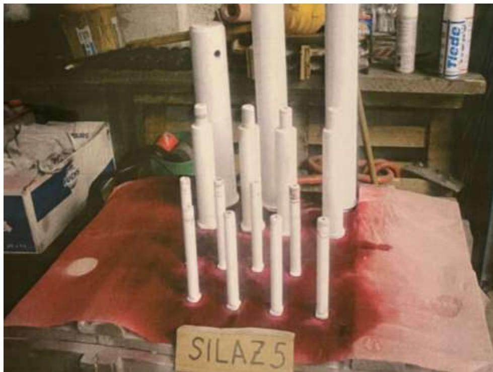
Slika 58 Penetrantsko ispitivanje svornjaka i osovina (2)
