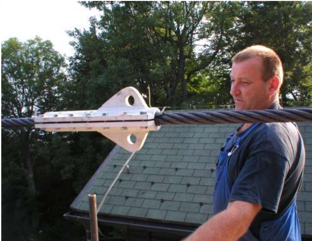
Slika 30 Dvodjelna naprava za potezanje
