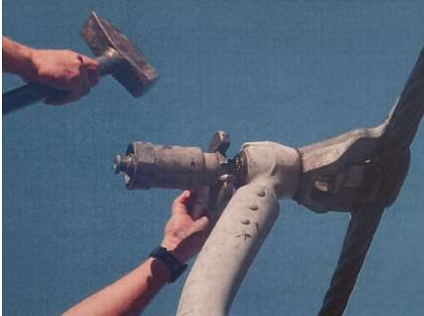
Slika 14 Hvataljka za pritezanje nosača sjedalice za pogonsko čelično uže
