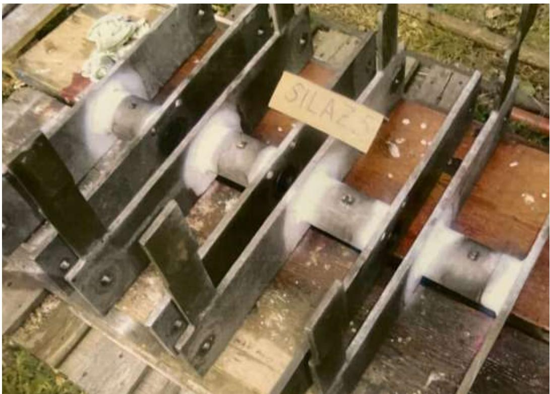
Slika 56 ispitivanje penetrantima podkonstrukcije velike i male vase (3)
