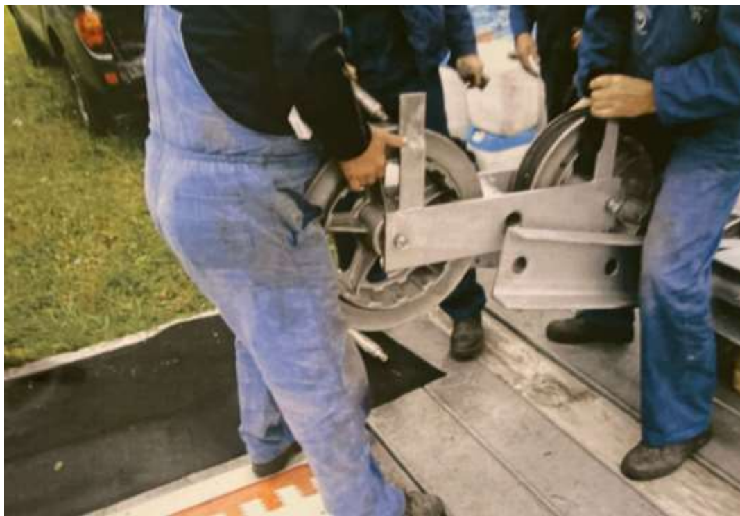
Slika 52 Kontrola ležajeva i njihovo zakretanje
