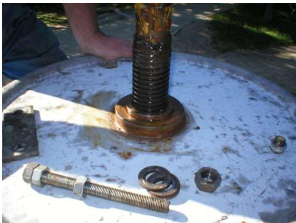
*Slika 37 Podizanje dvodijelnog vratila (1)*
