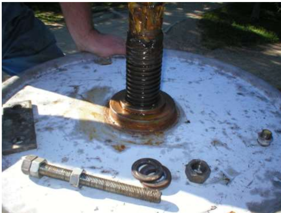
Slika 37 Podizanje dvodijelnog vratila (1)
