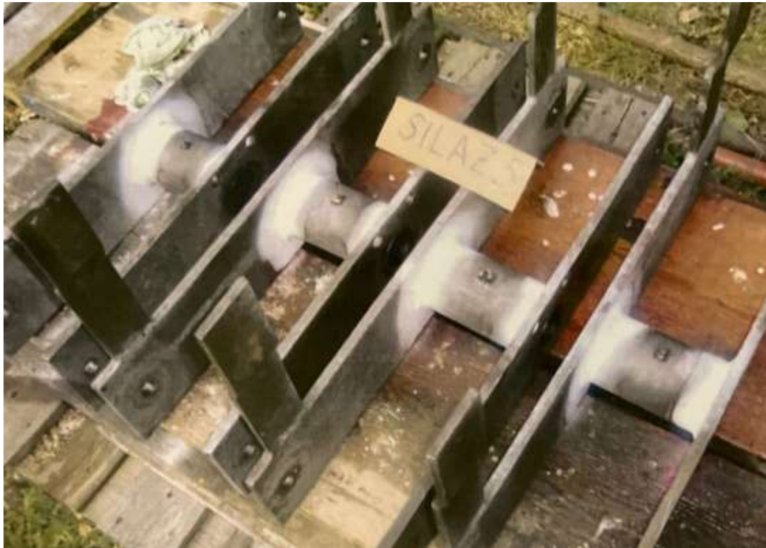
Slika 56 ispitivanje penetrantima podkonstrukcije velike i male vage (3)
