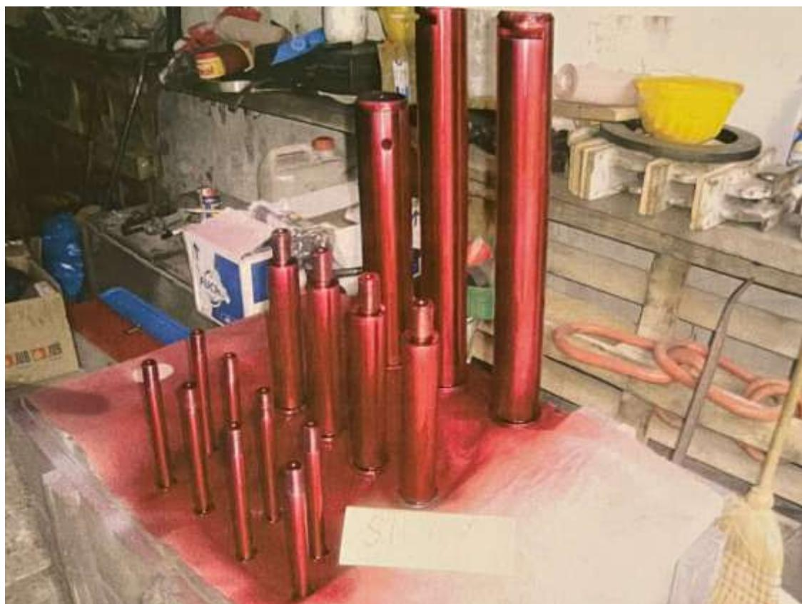
Slika 57 Penetrantsko ispitivanje svornjaka i osovina (1)
