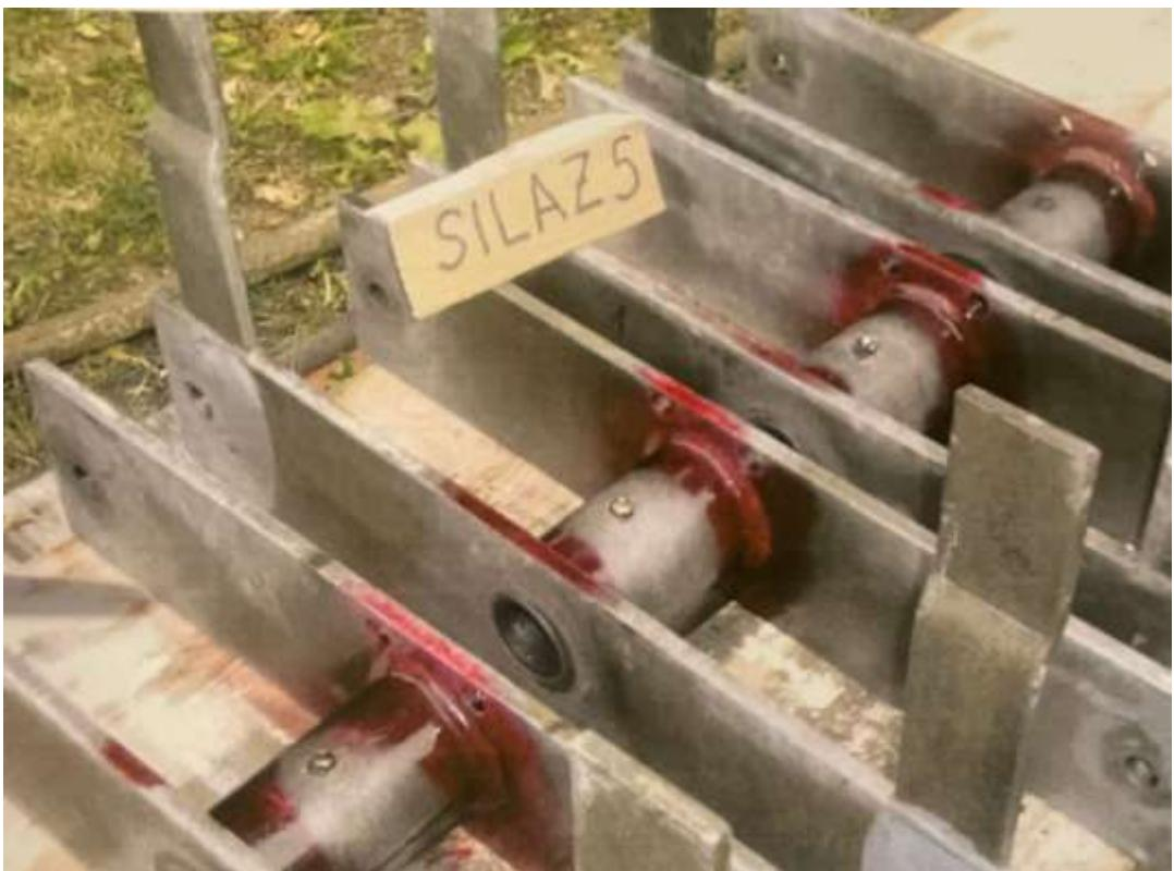
Slika 54 ispitivanje penetrantima podkonstrukcije velike i male vage (1)
