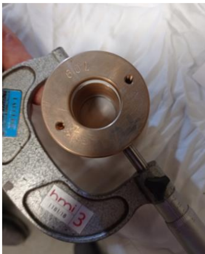
Slika 30. Nosač brtvila, \phi vanjski
