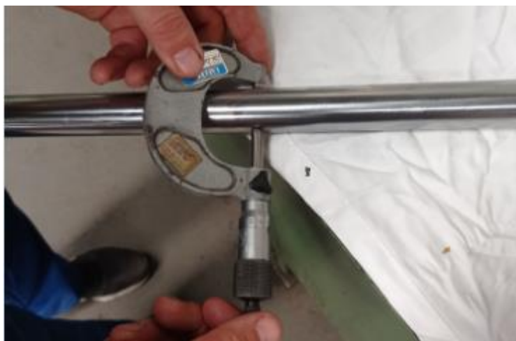
Slika 32. Klipnjača, \phi vanjski
