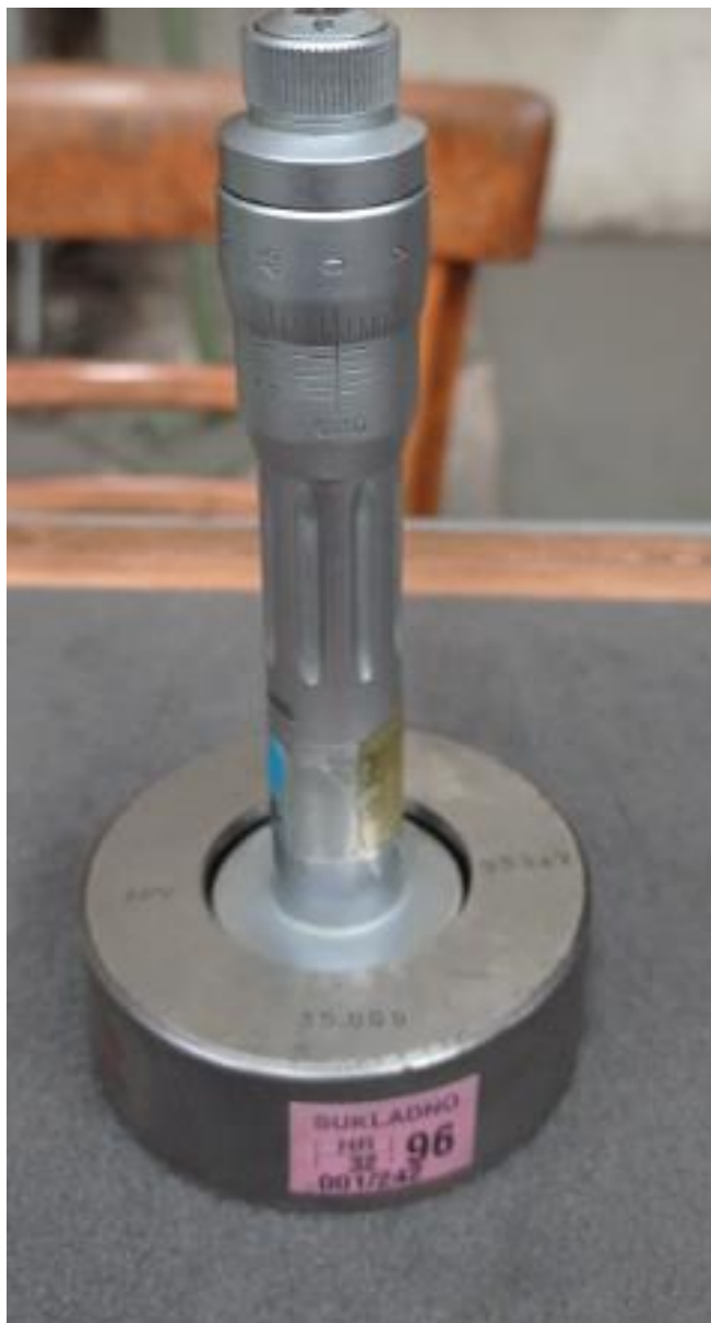
Slika 10. Umjeravanje mikrometra za unutrašnje mjerenje
