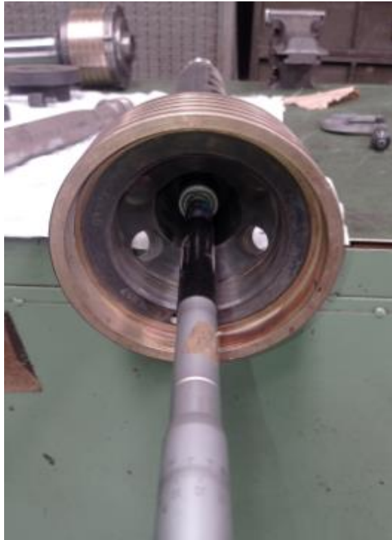
Slika 18. Klipnjača, \phi unutrašnji
