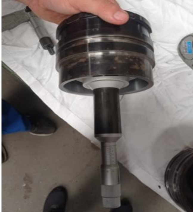
Slika 20. Tijelo kompenzatora, \phi unutrašnji
