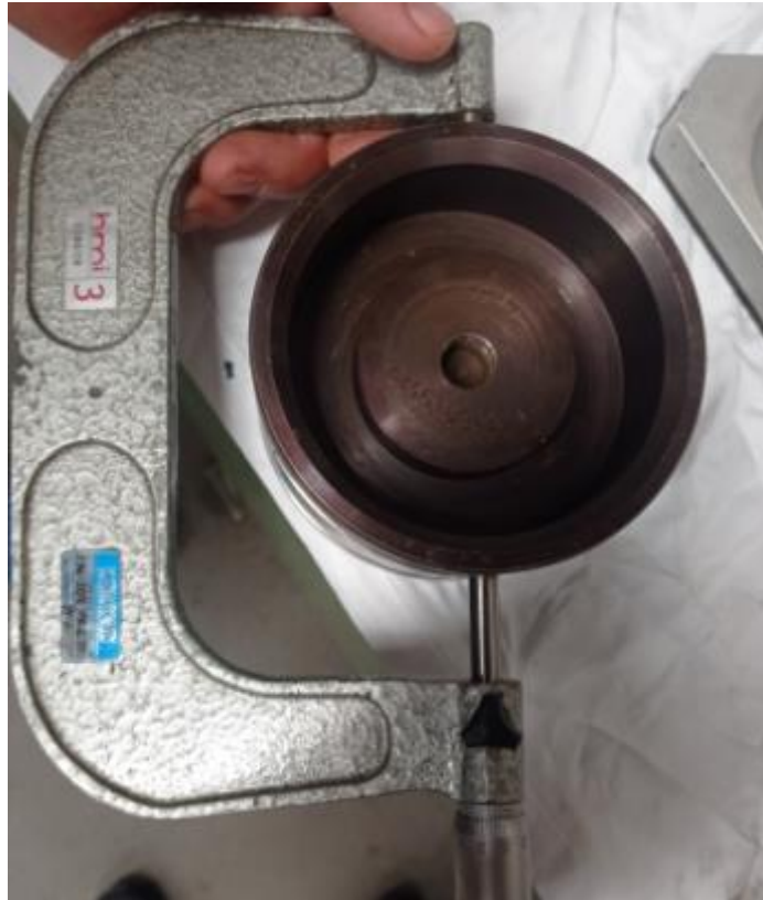
Slika 21. Klip , \phi vanjski
