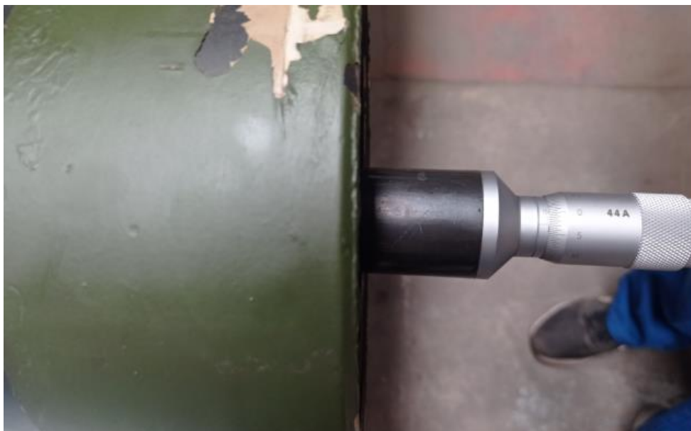
Slika 22. Cilindar hidraulične kočnice, \phi unutrašnji
