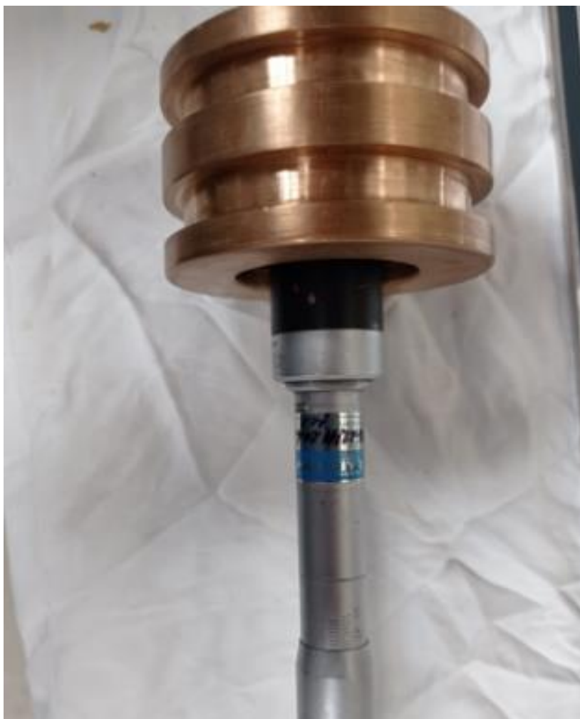
Slika 27. Nosač brtvila, \phi unutrašnji
