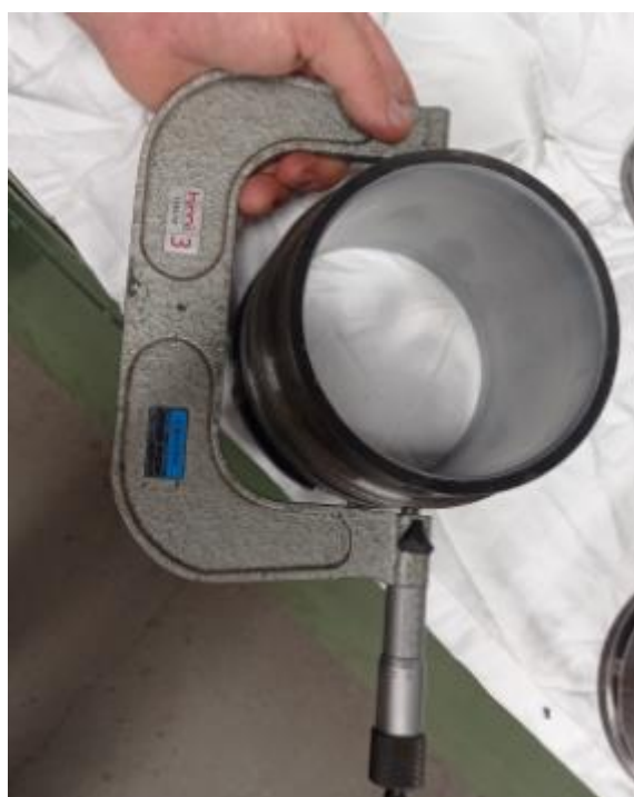
Slika 23. Tijelo kompenzatora, \phi vanjski
