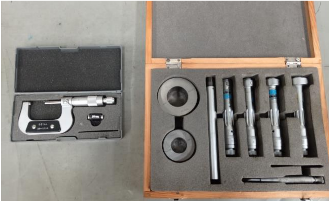
Slika 7. Mjerni uređaji sa etalonima za kontrolu
