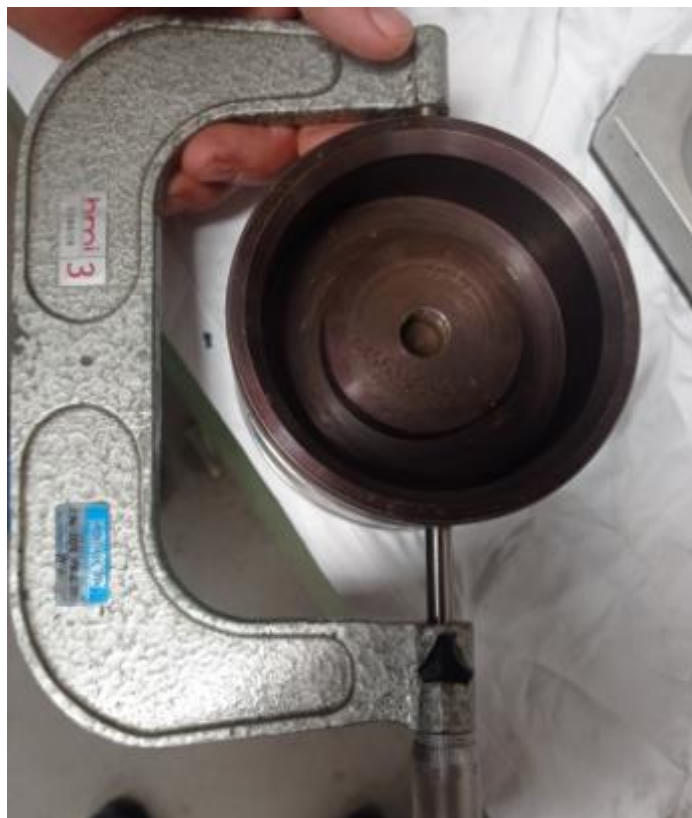
Slika 21. Klip , \phi vanjski
