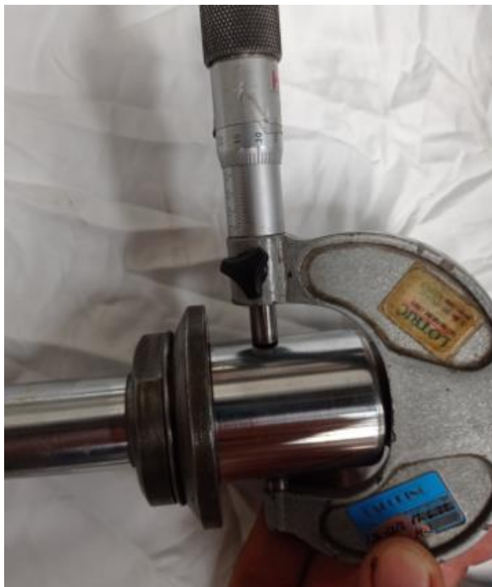
Slika 28. Glava klipnjače, \phi vanjski
