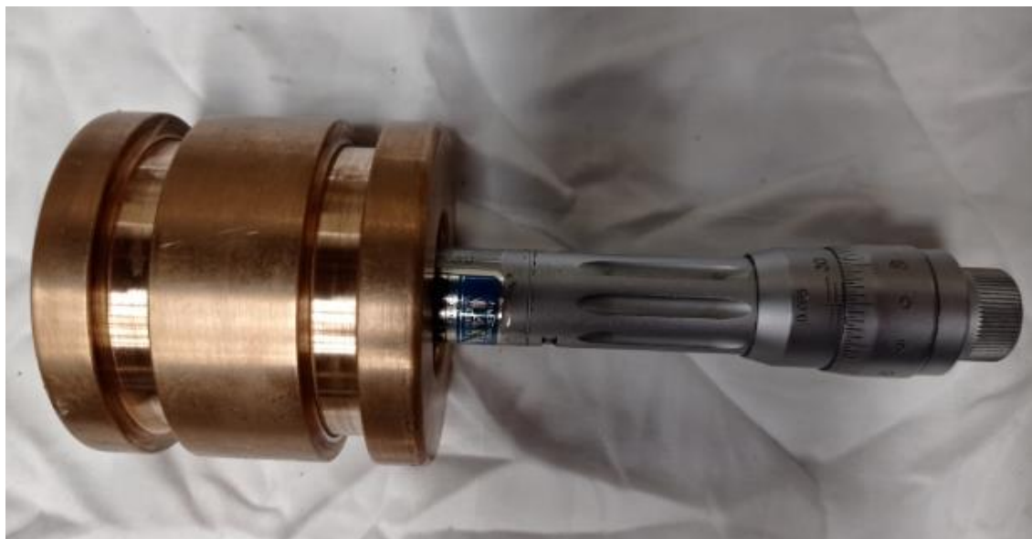
Slika 31. Nosač brtvila, \phi unutrašnji
