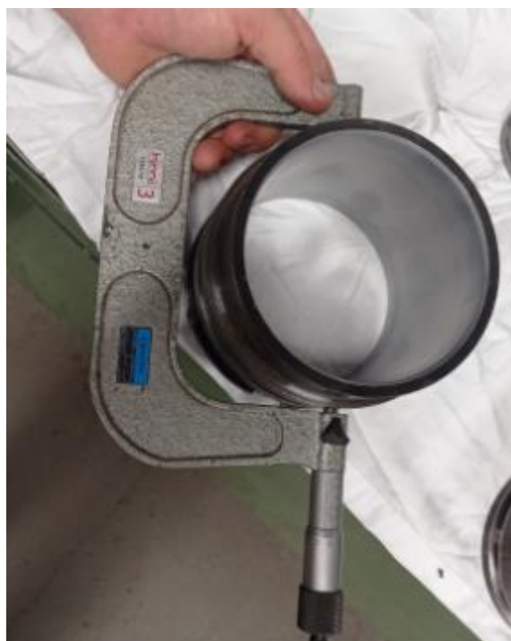
Slika 23. Tijelo kompenzatora, \phi vanjski
