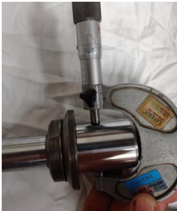
Slika 28. Glava klipnjače, \phi vanjski
