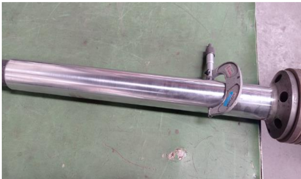
Slika 17. Klipnjača, \phi vanjski
