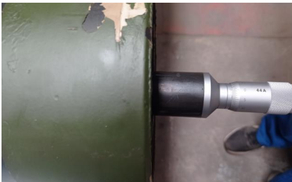
Slika 22. Cilindar hidraulične kočnice, \phi unutrašnji
