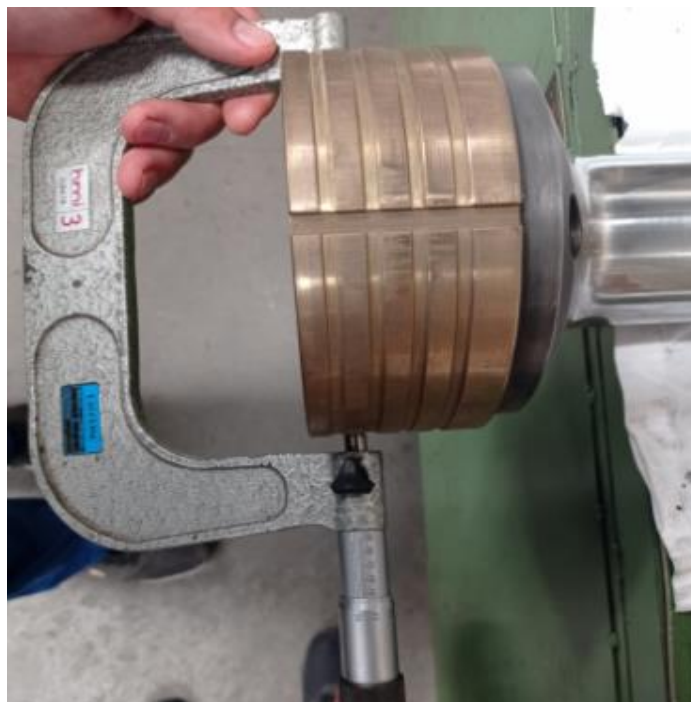
Slika 13. Košuljica klipnjače \phi vanjski
