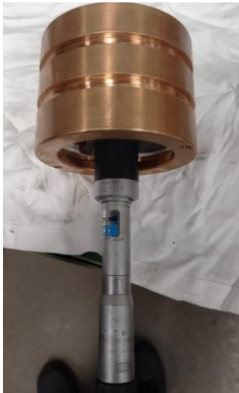
Slika 16. Nosač brtvila, \phi unutrašnji
