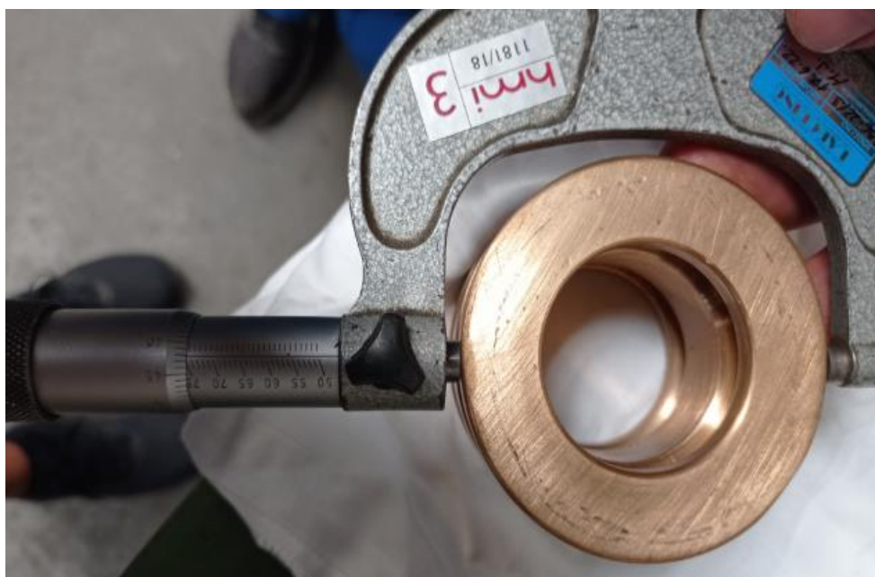
Slika 26. Nosač brtvila, \phi vanjski
