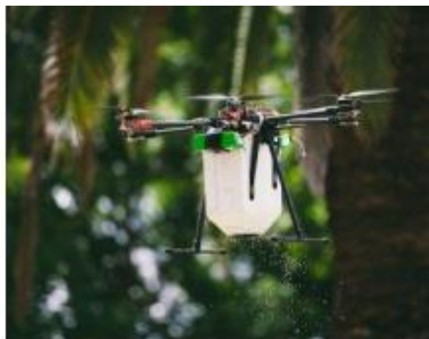
Slika 8: „Bug drone“ tijekom raspršivanja prirodnih neprijatelja štetnika
