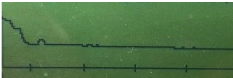
Slika 31. Efekt "ski-slope" na početku spektra ; Izvorno autor
