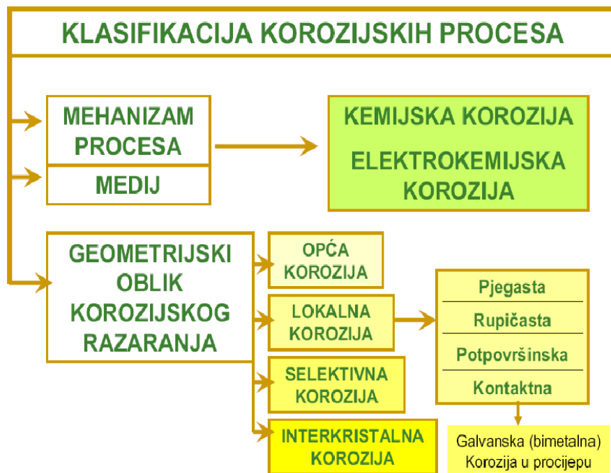
Slika 3. Klasifikacija korozijskih procesa [9]
