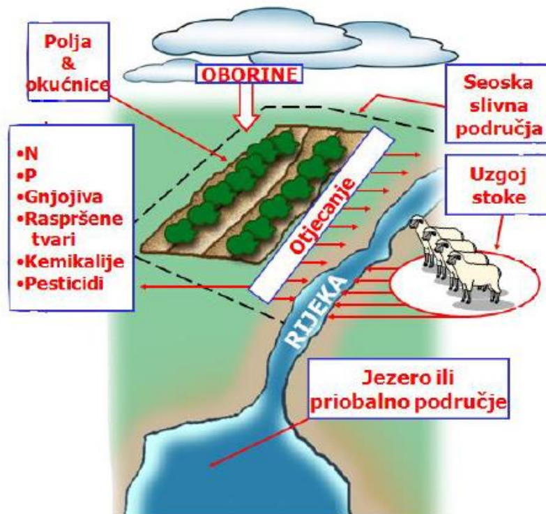
Slika 5. Prikaz nastanka otpadnih oborinskih voda
