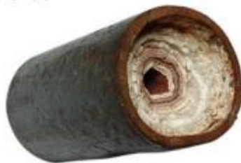
Slika 18. Prikaz cijevi s nakupinama kamenca
