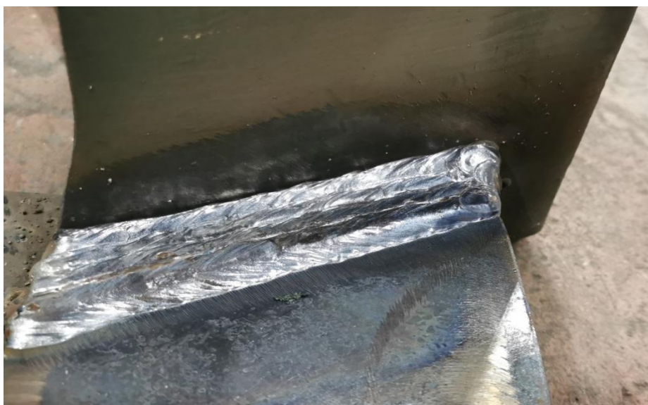
Slika 47. Vizualna kontrola lica zavora jednog od osam spojeva
