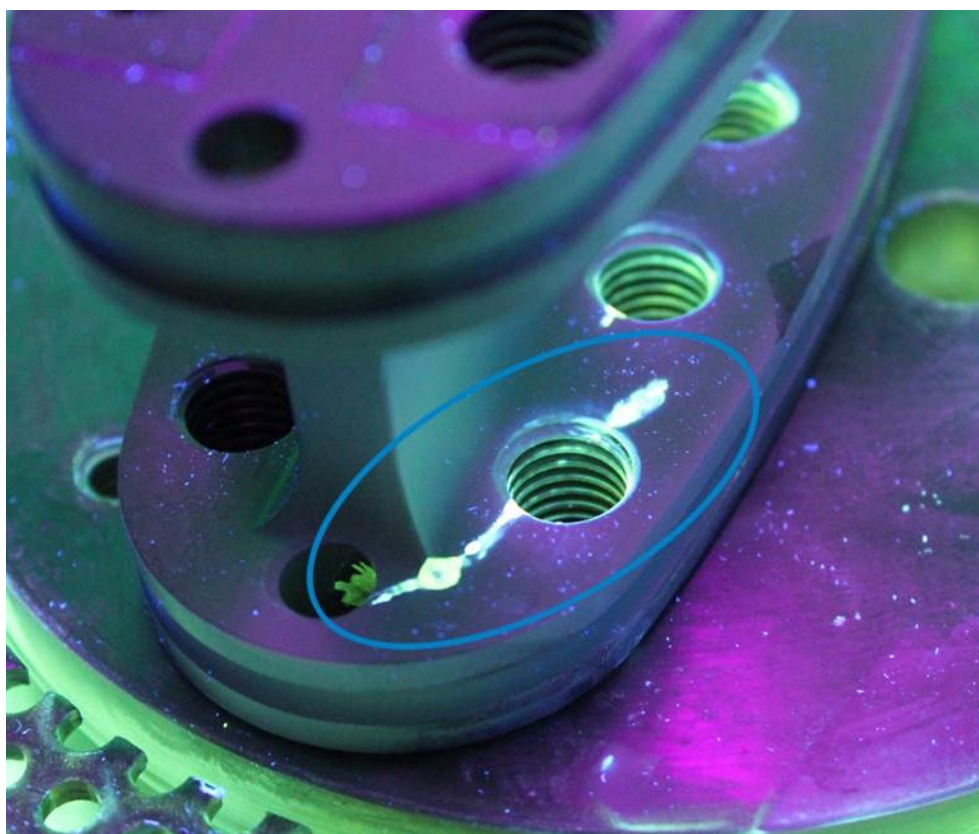
Slika 12. Primjer ispitivanja i indikacije fluorescentnim penetrantom [19]
