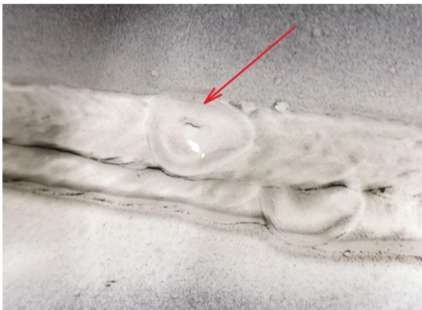
Slika 53. Pukotina u završnom krateru
