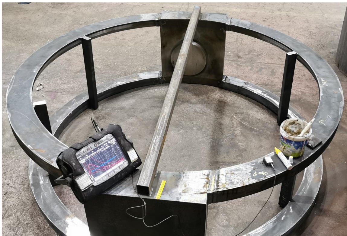
Slika 49. Ultrazvučna kontrola jednog od osam spojeva
