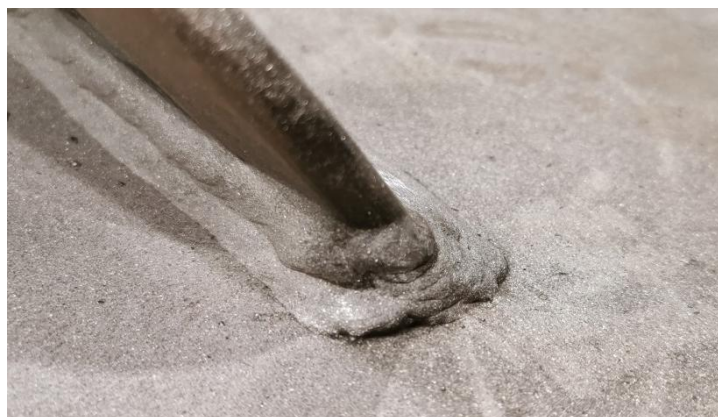
Slika 62. Vizualna greška: preklop zavora
