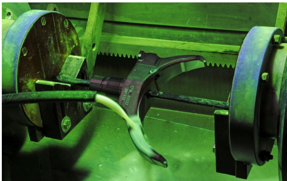
Slika 21. Magnetizacija uređajem za magnetizaciju metodom fluorescentnih magnetskih čestica [29]
