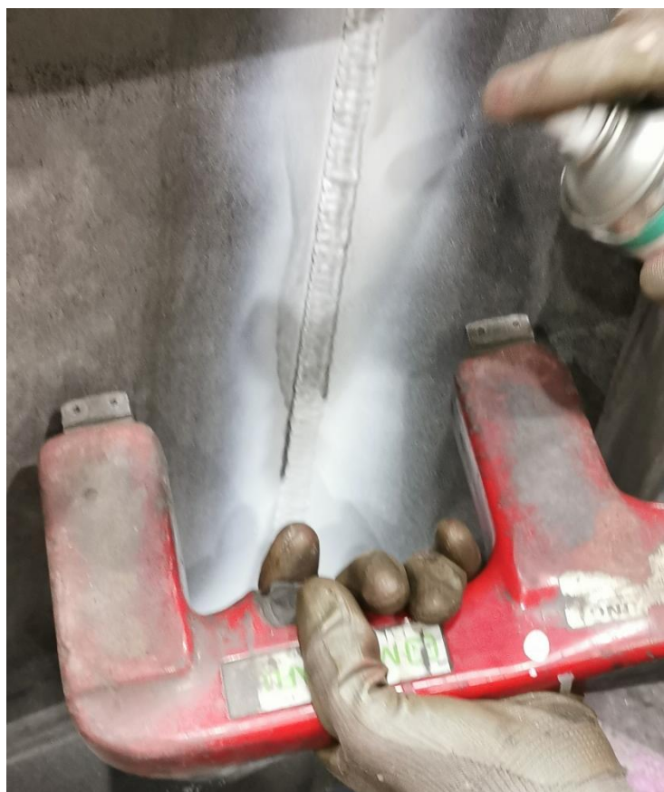
Slika 54. Prikaz rada magnetskom kontrolom obojanim česticama
