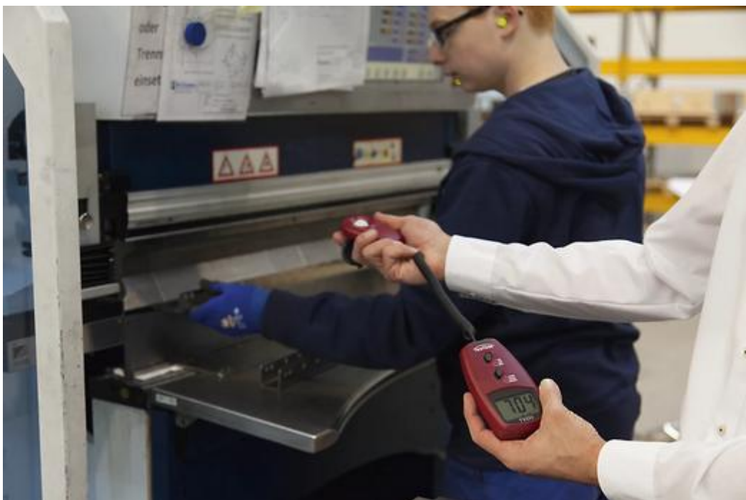
Slika 4. Mjerenje osvjetljenja fotometrom [11]
