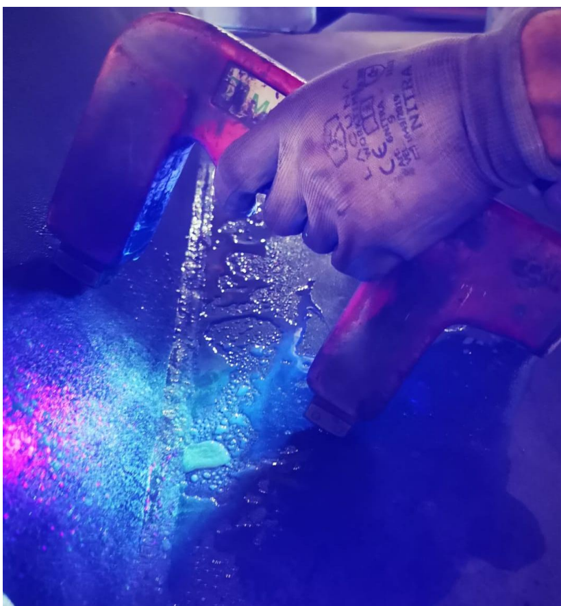
Slika 64. Magnetska kontrola zavarenih spojeva na zapornom tijelu
