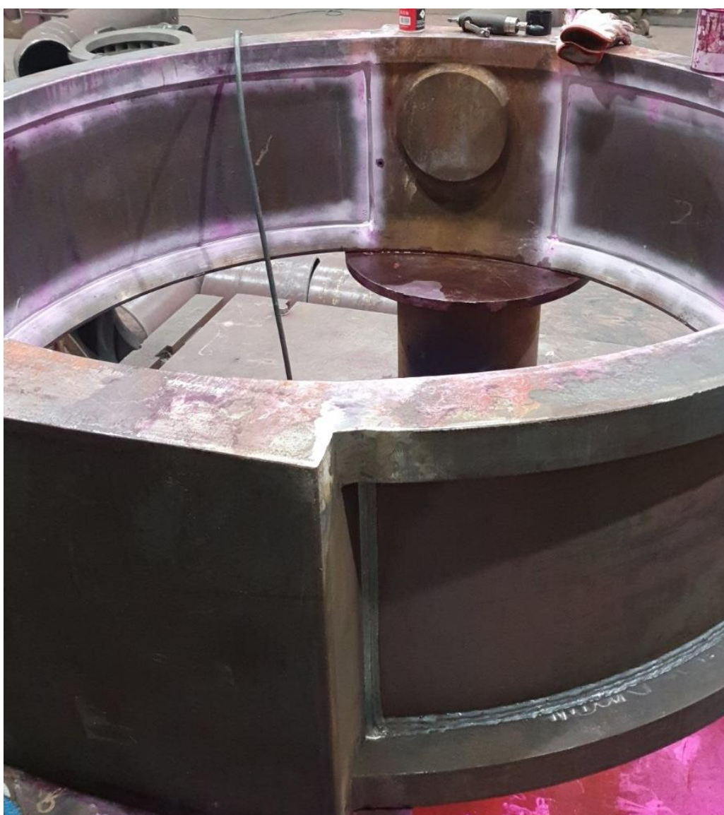
Slika 51. Penetrantska kontrola nakon brušenja korijena
