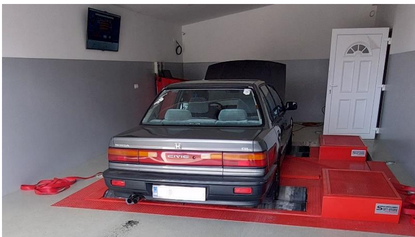
Slika 25: Automobil na ispitnim valjcima
