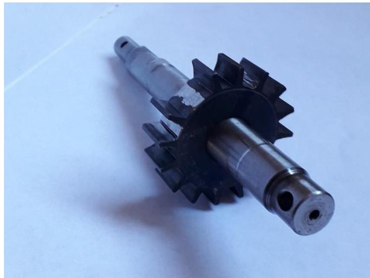
Slika 8: Zupčanik senzora položaja motora
