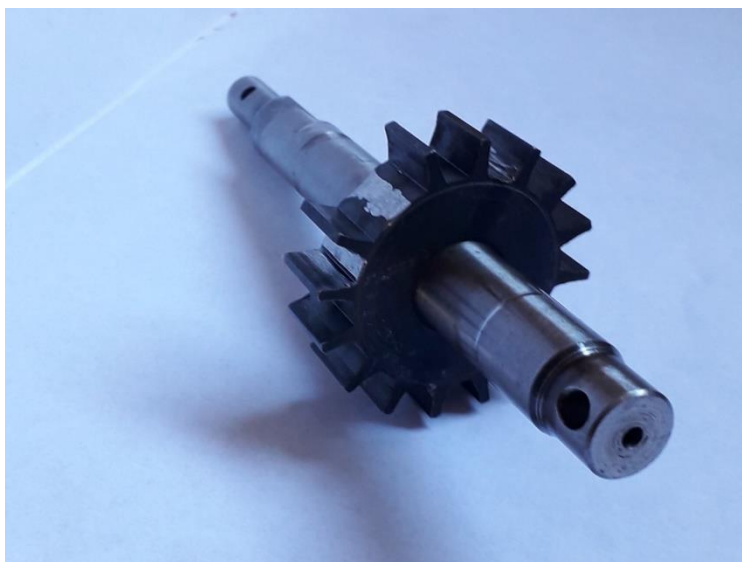
Slika 8: Zupčanik senzora položaja motora
