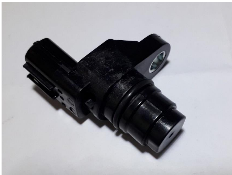
Slika 9: Hall efekt senzor položaja motora
