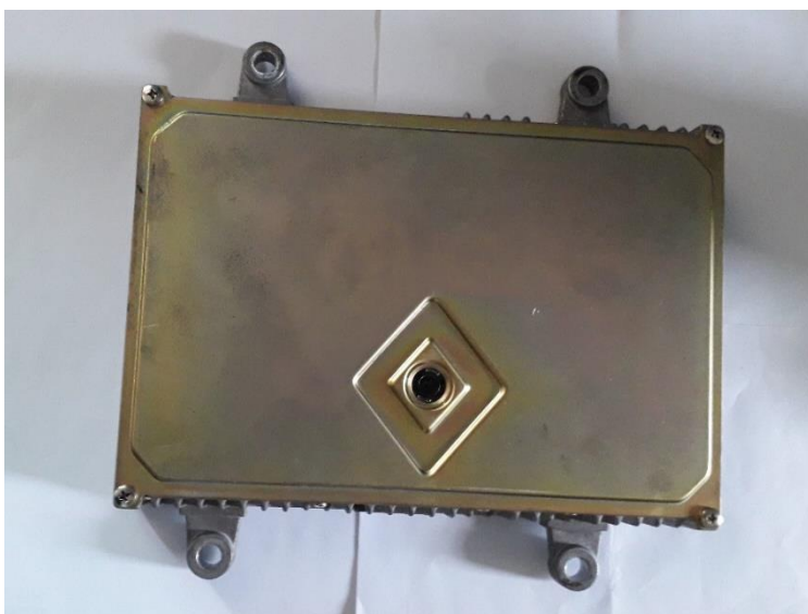
Slika 7: Upravljačka jedinica motora vozila Honda Civic
