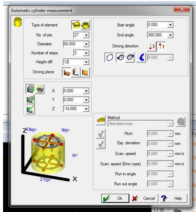
Slika 46. Postavke za automatsko mjerenje valjka
