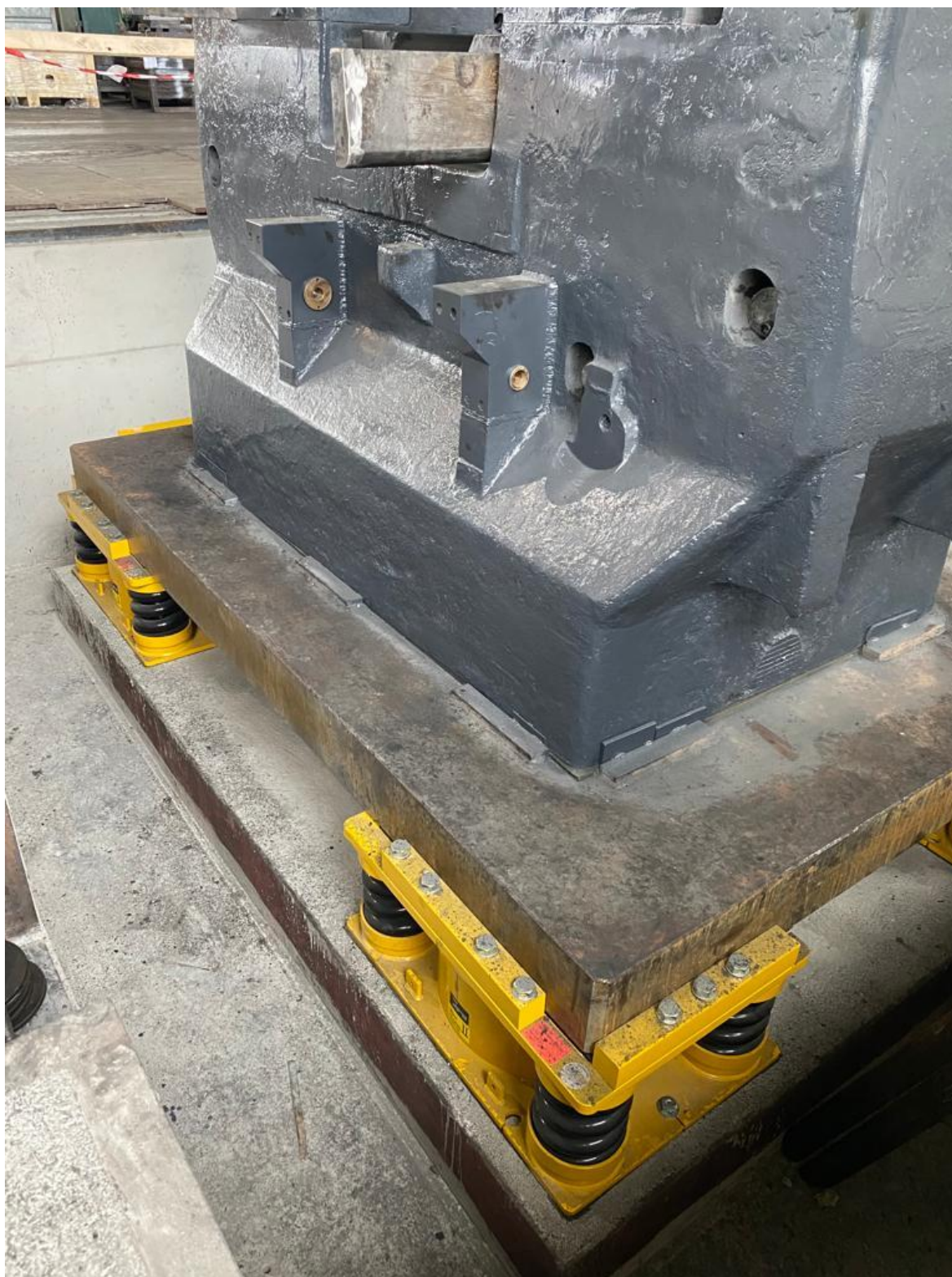
Slika 11 Temelji sa Gerb nosačima
