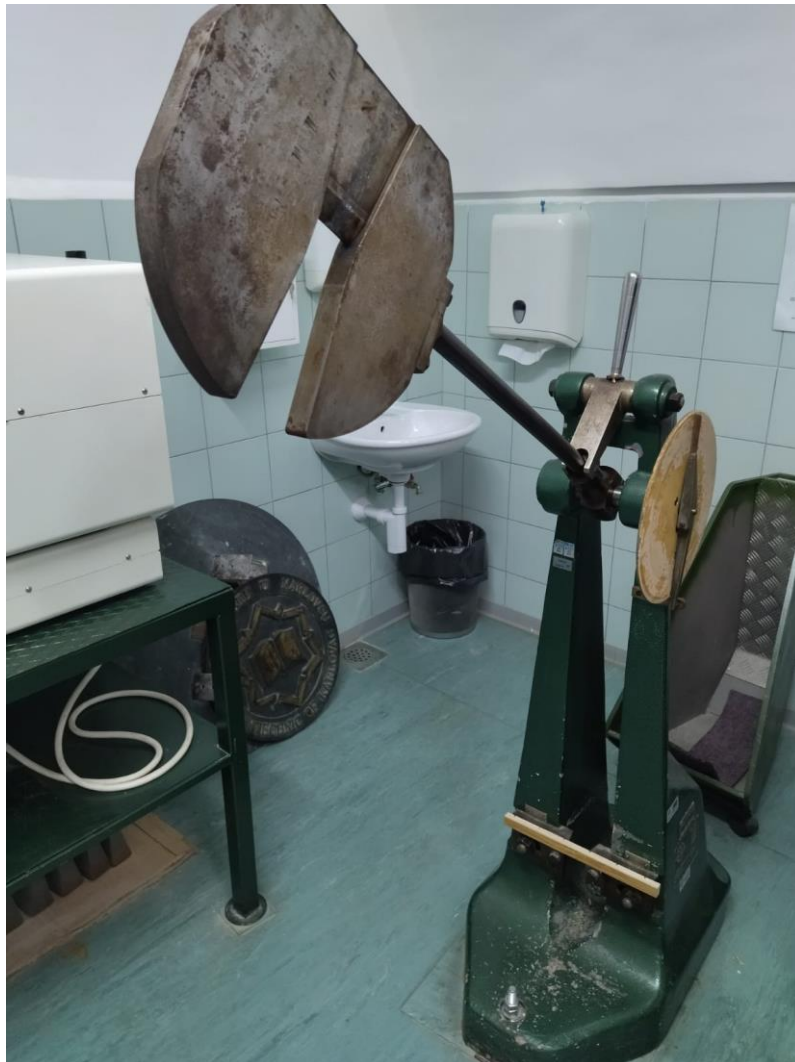
Slika 22. Slika uzorka postavljenog na Charpy batu
