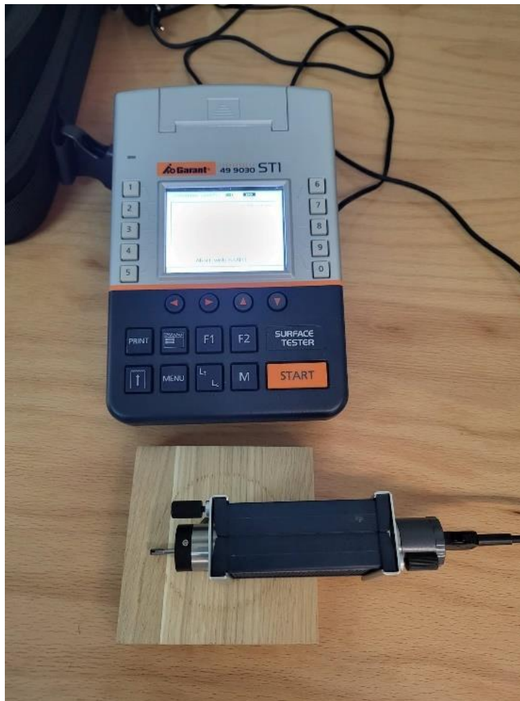
Slika 17. Prikaz ispitivanja hrapavosti površine [1]
