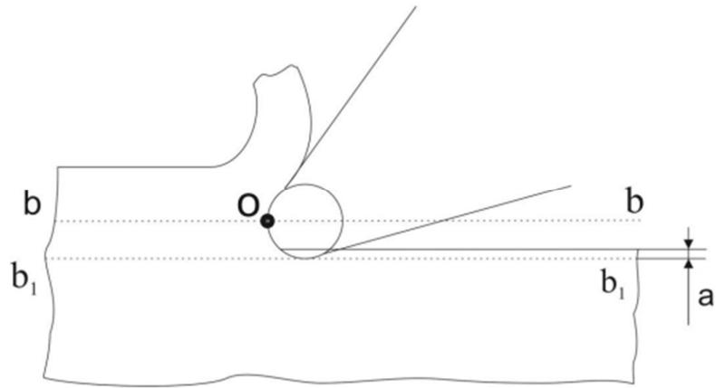
*Slika 3: Prikaz realne oštice u zahvatu s drvenim obratkom [3]*
