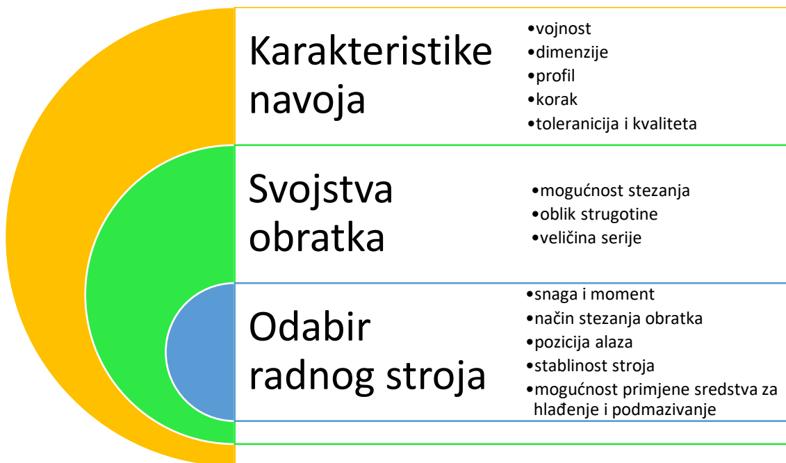
Slika 29 Elementi za tokarenje navoj
