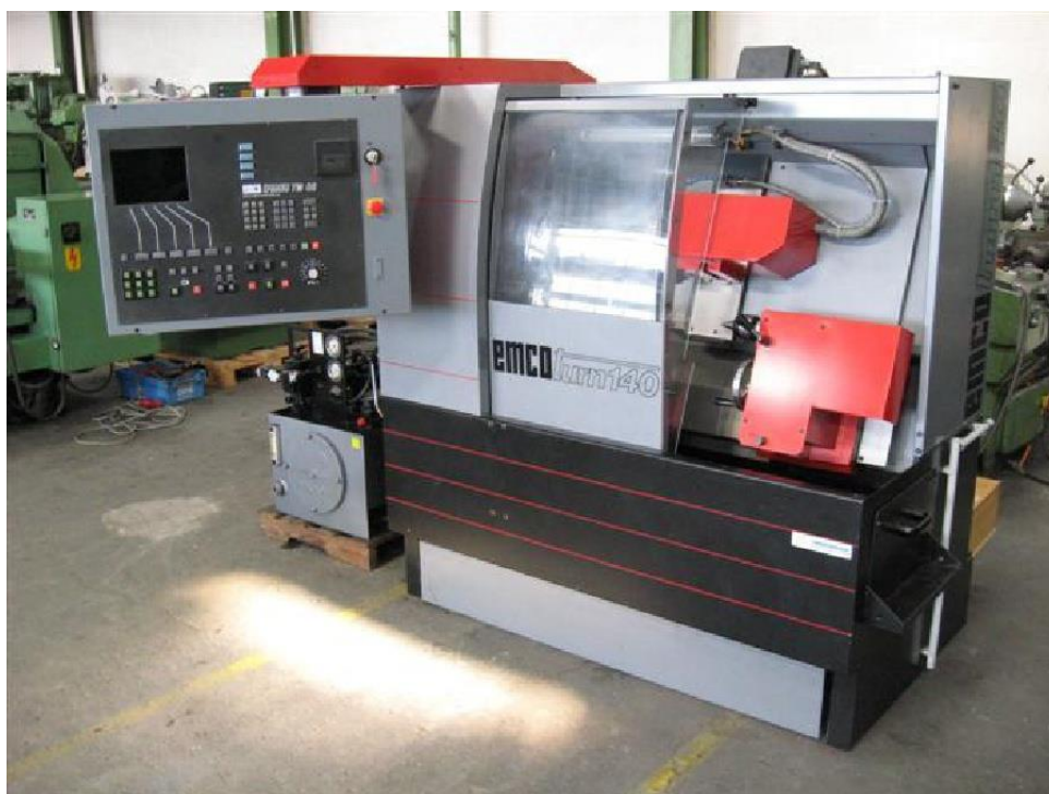
Slika 11 Numerički upravljana tokarilica [18]
