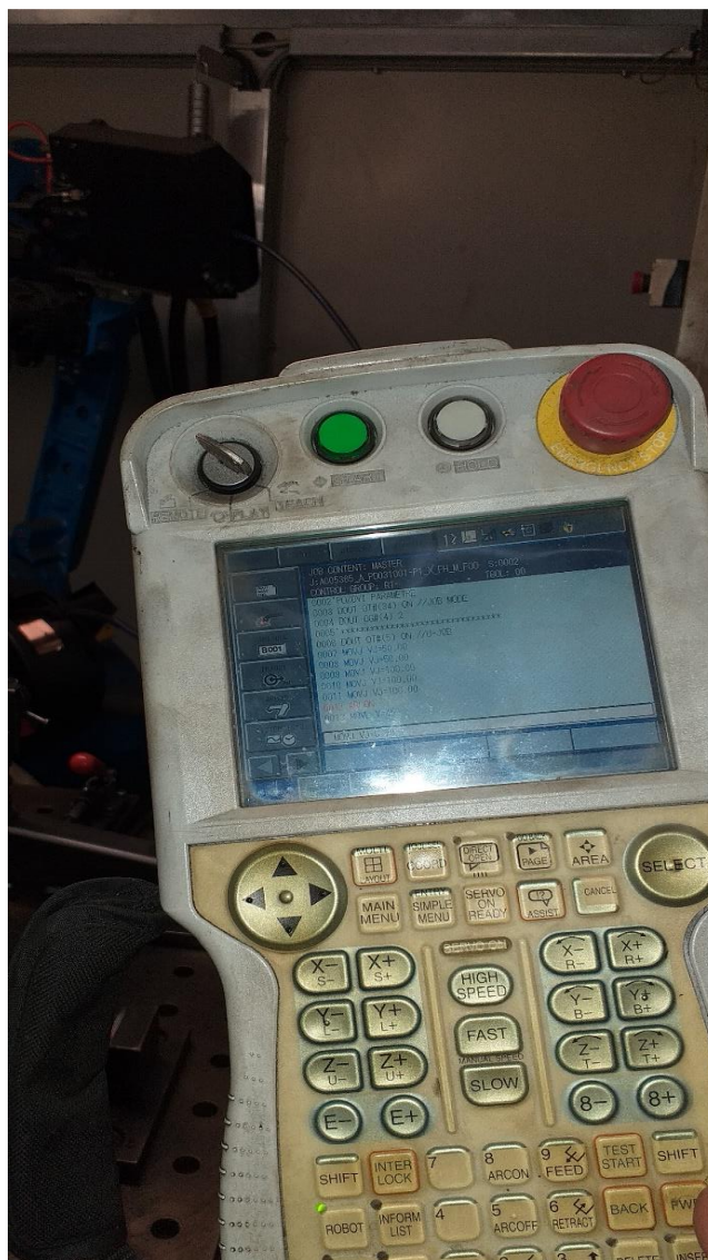
Slika 34. Džojstik za ručno programiranje [17]
