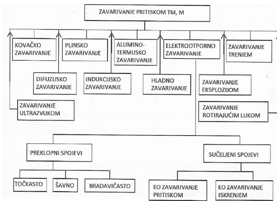
Slika 2. Podjela postupaka zavarivanja pritiskom [6]
