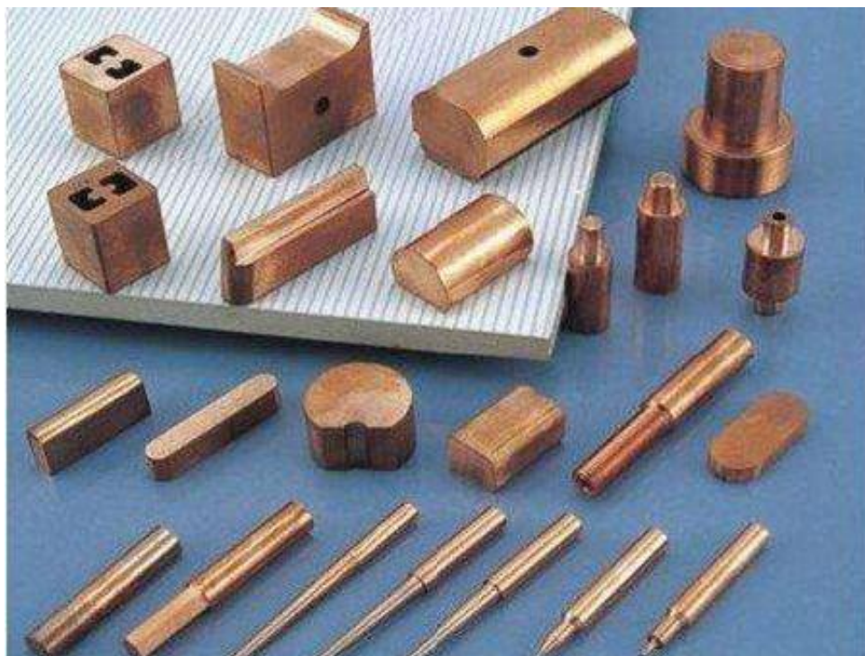
Slika 16 Primjer alata (elektroda) za obradu [17]
