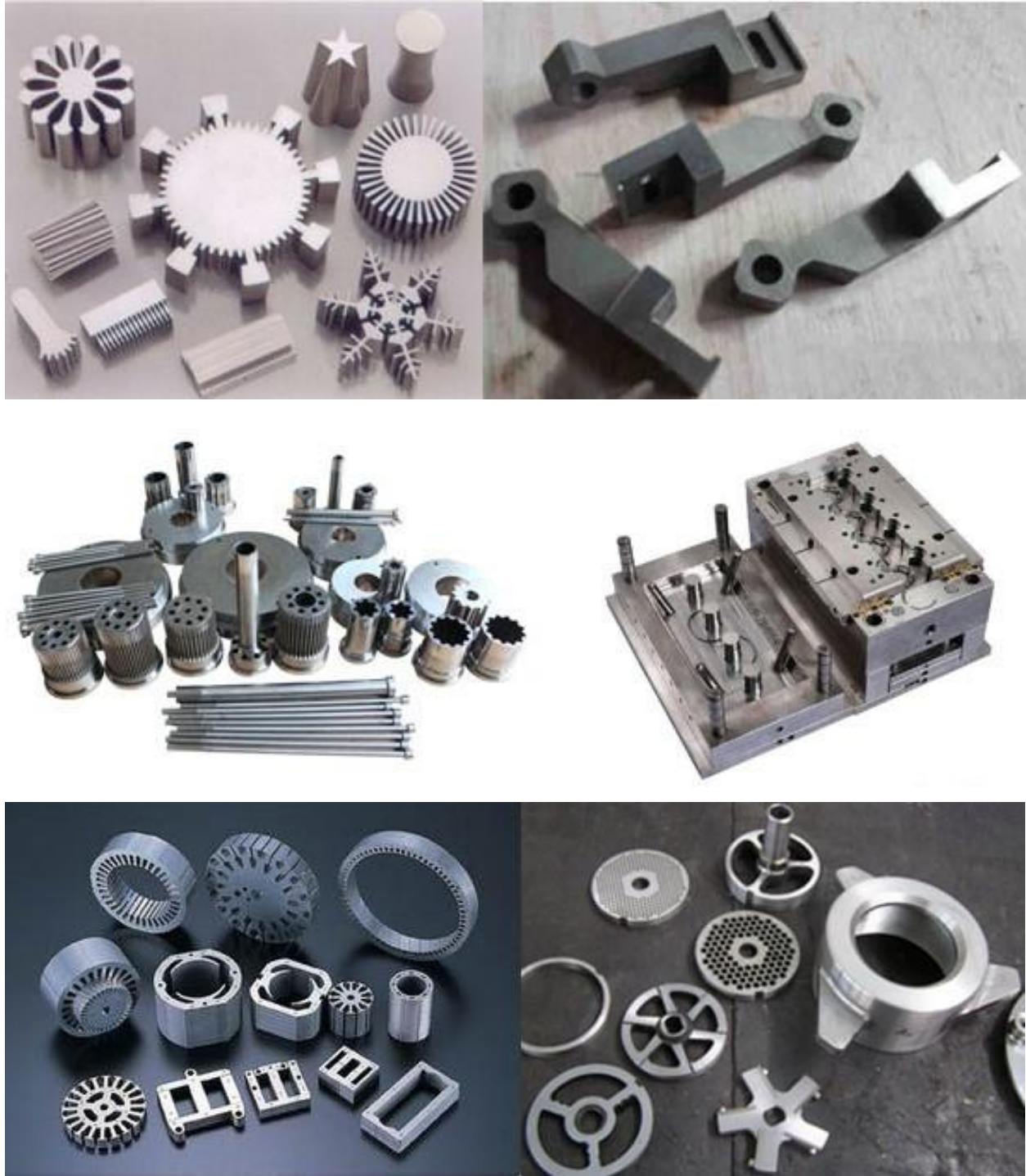
Slika 14 Proizvodi dobiveni elektroerozijom žicom [15]
