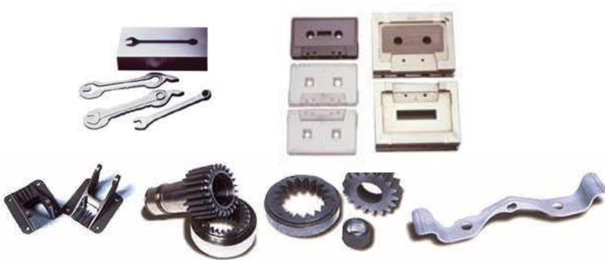
Slika 8 Proizvodi dobiveni elektroerozijom [4]
