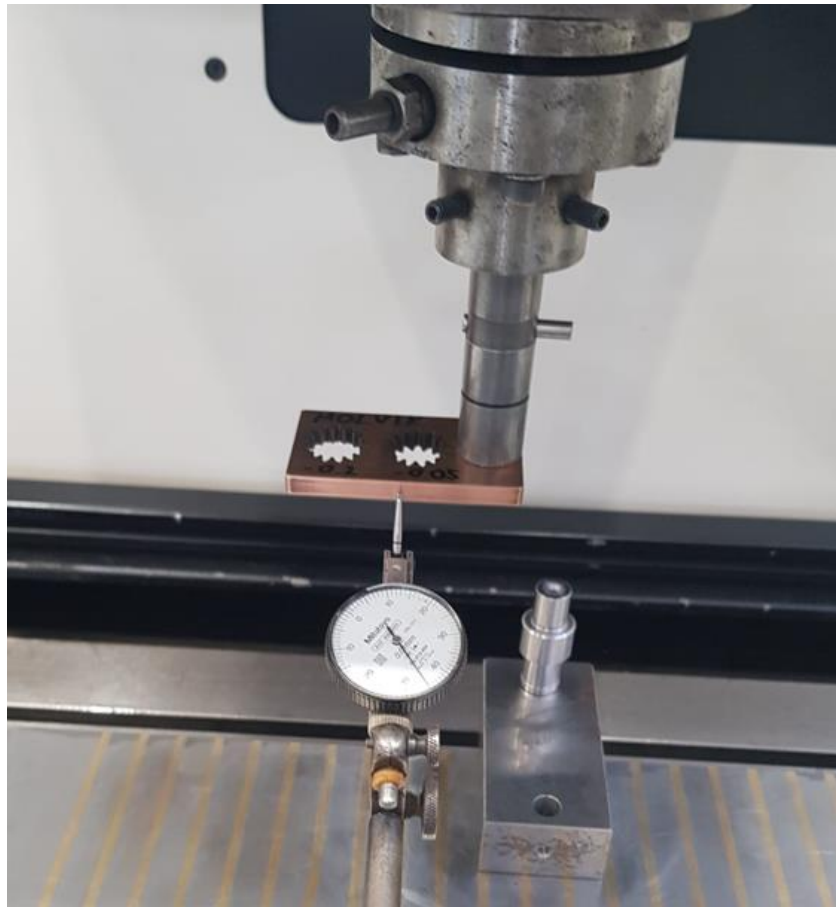
Slika 48 Kompariranje elektrode po x osi
