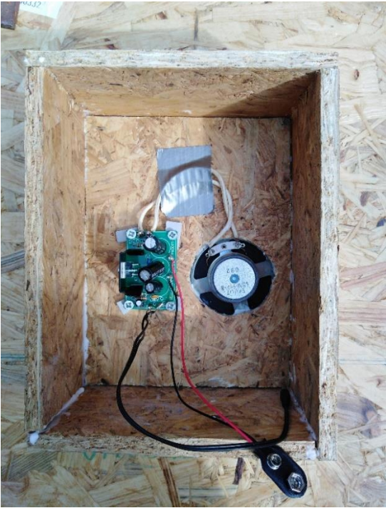
Slika 14. Zvučnička kutija prije postavljanja stražnje stranice
