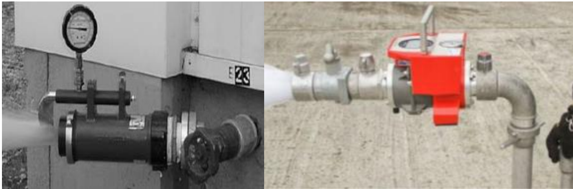
Slika 24. Mjerenje pomoću Pitot cijevi s kalibriranom mlaznicom, i pomoću posebnog mjerača s elektromagnetnim senzorom[24]
