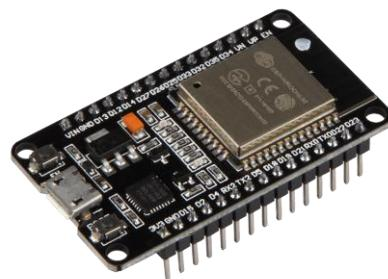
Slika 4. ESP32 mikrokontroler
