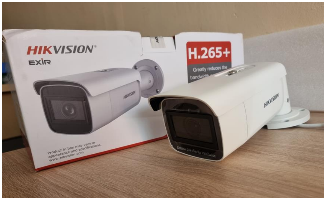
Slika 4. Prikaz kamere za opći nadzor javnih površina koja se također koristi za nadzor prometa u mirovanju [Izvor: fotografija autora]
