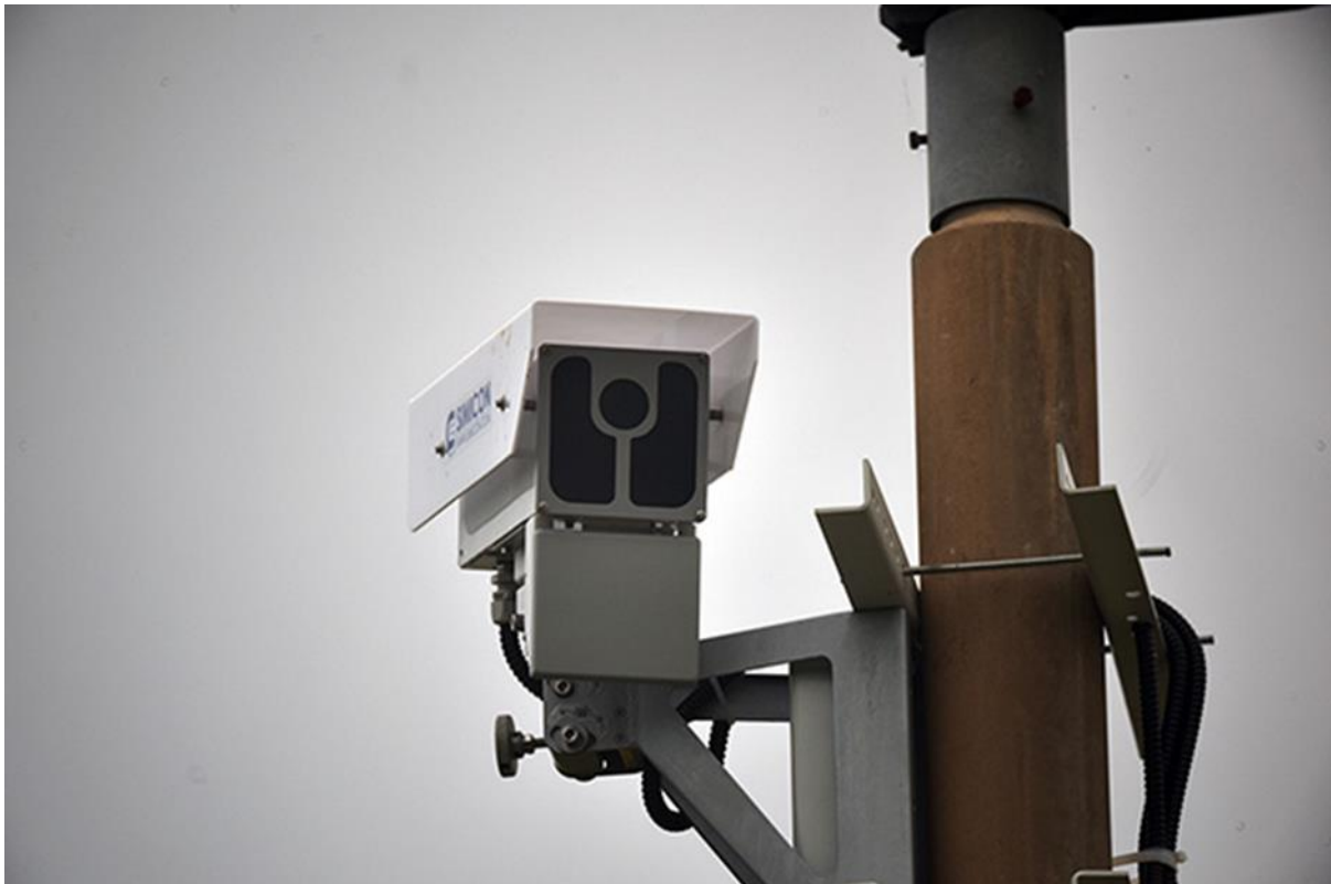
Slika 2. Prikaz kamere za nadzor brzine i vozila u kretanju [5]
