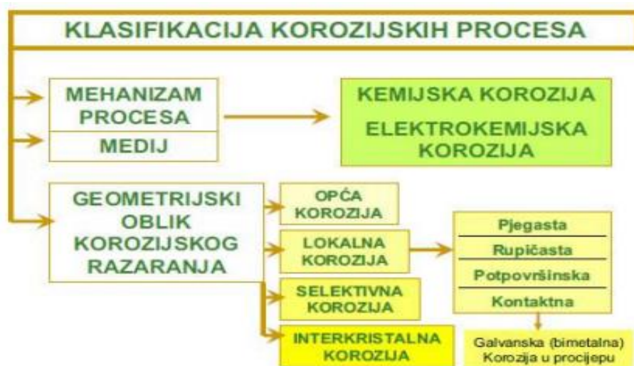
Slika 6. Klasifikacija korozijskih proces [7]
