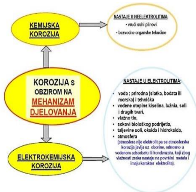
Slika 7. Podjela korozije prema mehanizmu djelovanja [6]
