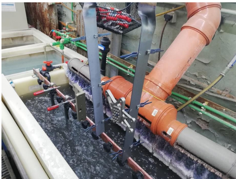
Slika 18. Kada za eloksiranje i postupak
