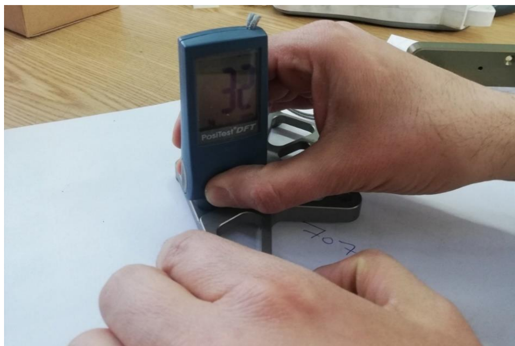
Slika 25. Provjera debljina nanosa – 3
