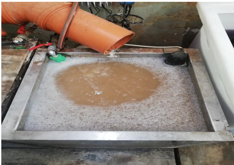
Slika 15. Kada za odmaščivanje obradaka u alkalnom deterdžentu
