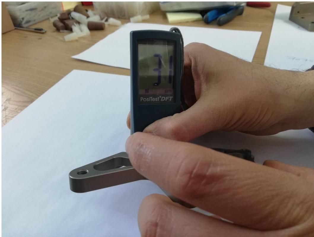
Slika 26. Provjera debljina nanosa – 4
