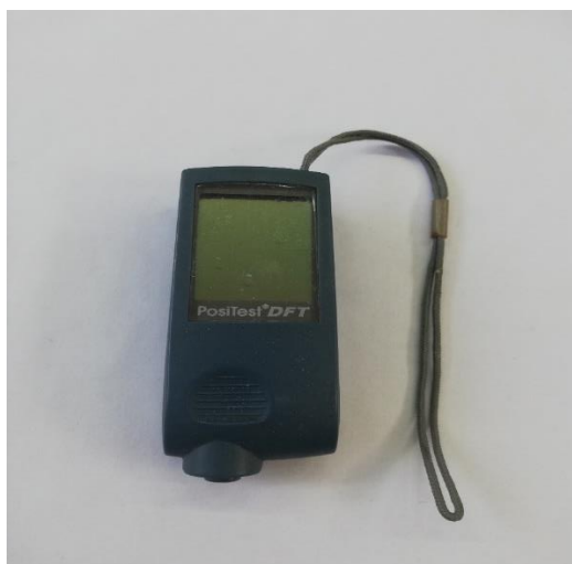
Slika 22. Mjerač debljine nanosa DFT Combo
