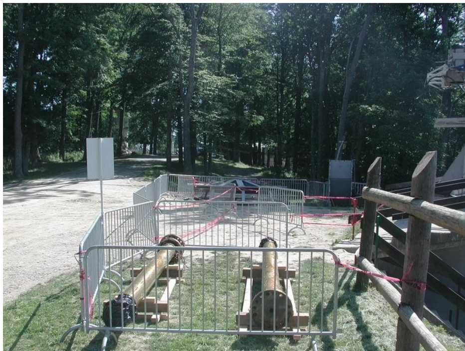
Slika 42. Gornji i donji dio vratila na pripremljenom mjestu za ispitivanje penetrantskim tekućinama [7]
