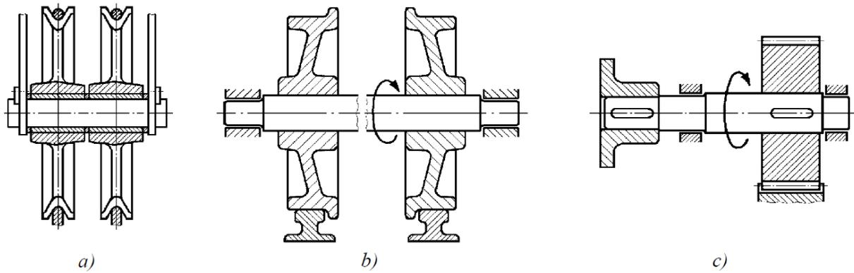
Slika 4. Konstrukcijske izvedbe osovine i vratila
