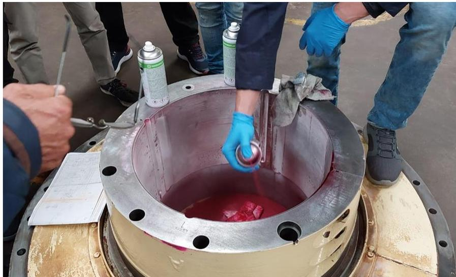
Slika 13. Nanošenje penetranta [7]
