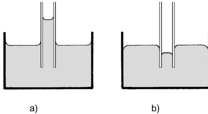
Slika 10. Kapilarno uzdizanje (a) i kapilarno spuštanje (b) [6]
