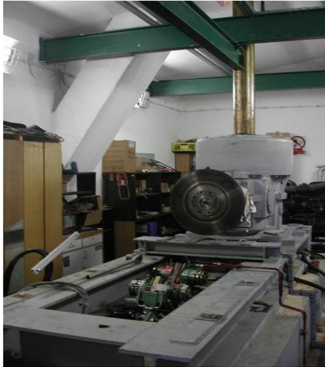
Slika 34. Demontirani motor, kardanski spoj i kočioni sustav [7]
