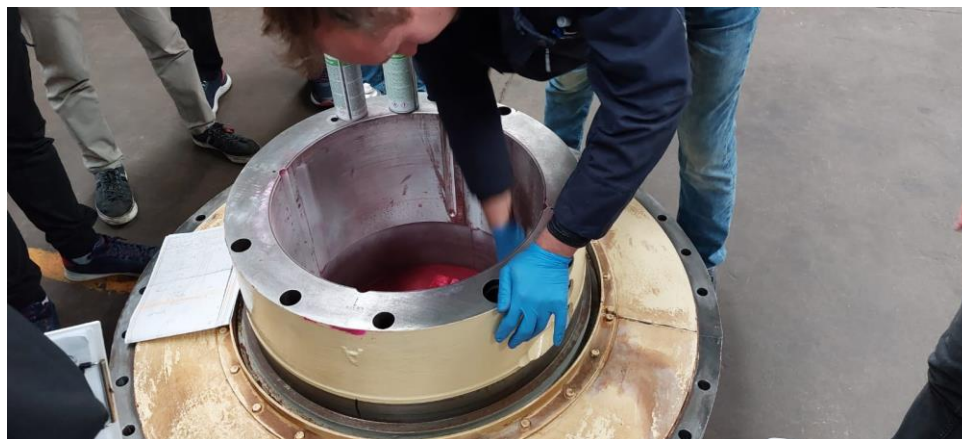
Slika 14. Uklanjanje viška penetranta [7]
