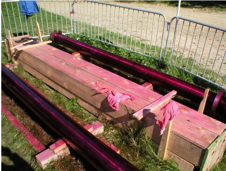
Slika 43. Nanošenje penetranta [7]
