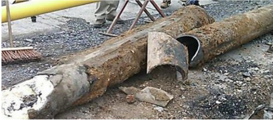
Slika 19. Grafitizacija sivog lijeva
