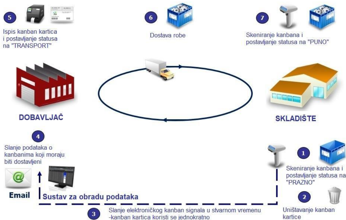
Slika 4 Shema Kanban sustava [4]
