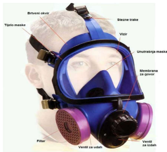
Slika 12. Dijelovi maske za lice [15]
