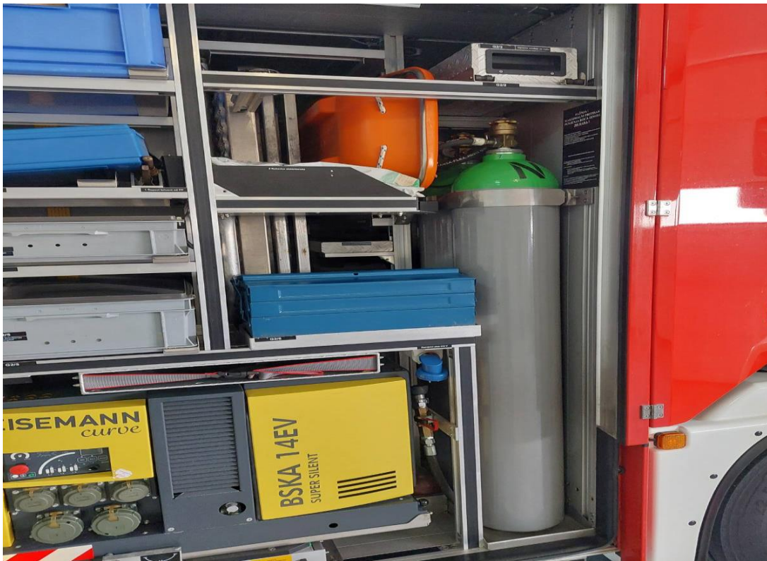
Slika 4. Spremnik za sistem za dodavanja zraka motoru velikog tunelskog vozila (vlastiti izvor)
