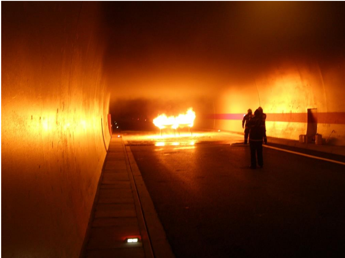
Slika 6. Primjer stratifikacije dima u tunelu Mala Kapela (vlastiti izvor)
