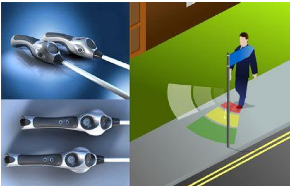
Slika 1. Bazični izgled i ergonomski dizajn Ultra Cane elektronskog slijepog štapa [12]
