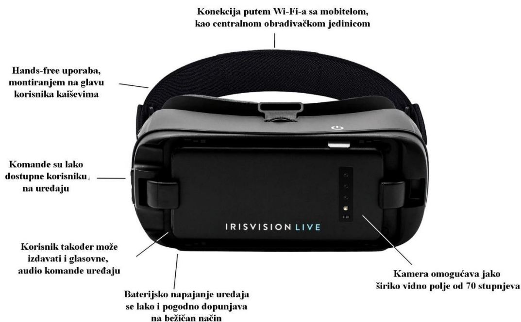
Slika 5. IrisVision Live VR uređaj i osnovne funkcije [16]
