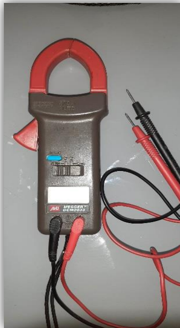
Slika 12. Strujna kliješta MEGGER DCM2033
