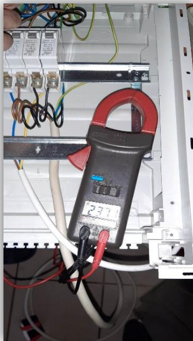
Slika 15. Napon kada je friteza uključena
