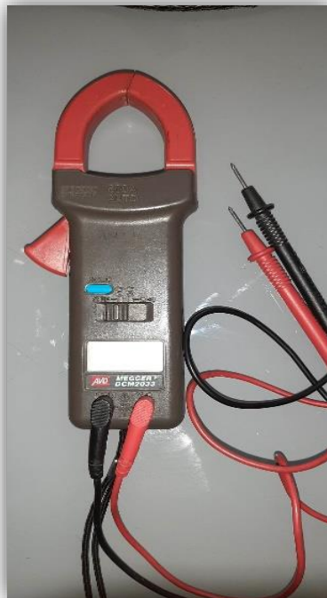
Slika 12. Strujna kliješta MEGGER DCM2033
