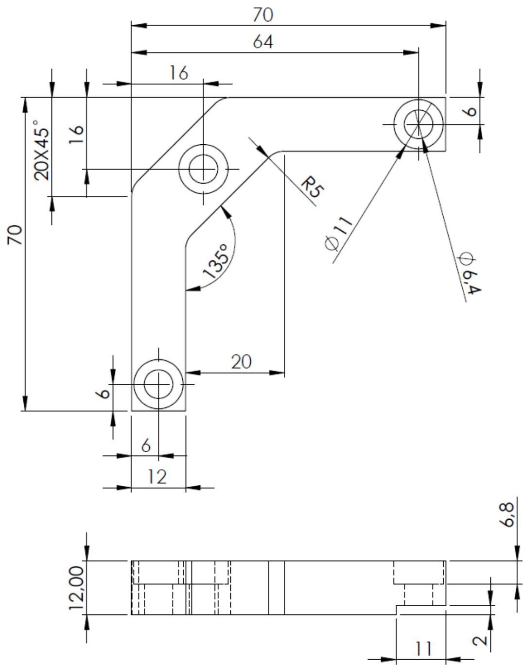
Slika 25. Skica lijevog nosača svjetla
