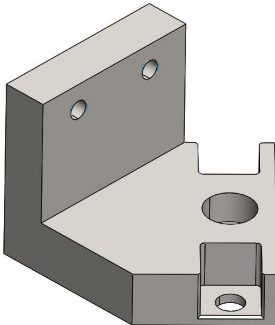
Slika 30. 3D model nosača svijetla
