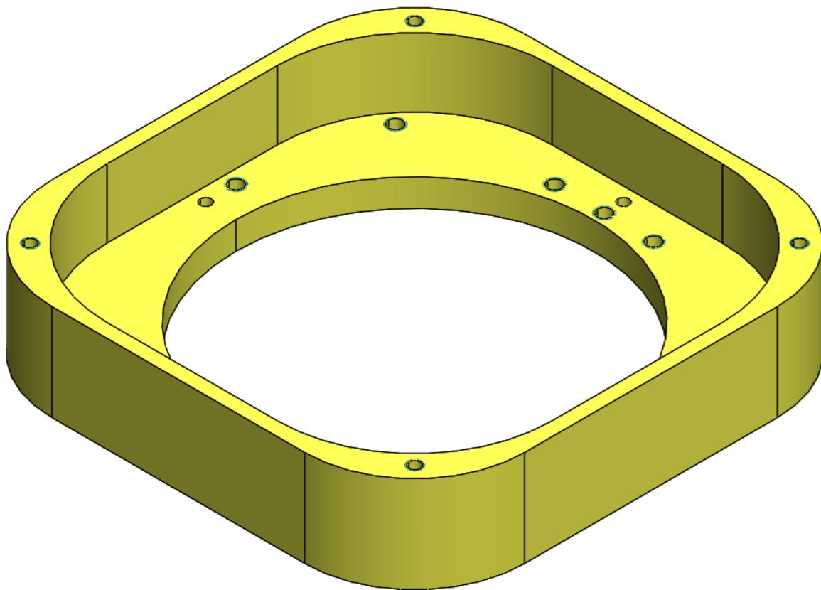
Slika 32. 3D model poklopca svjetla
