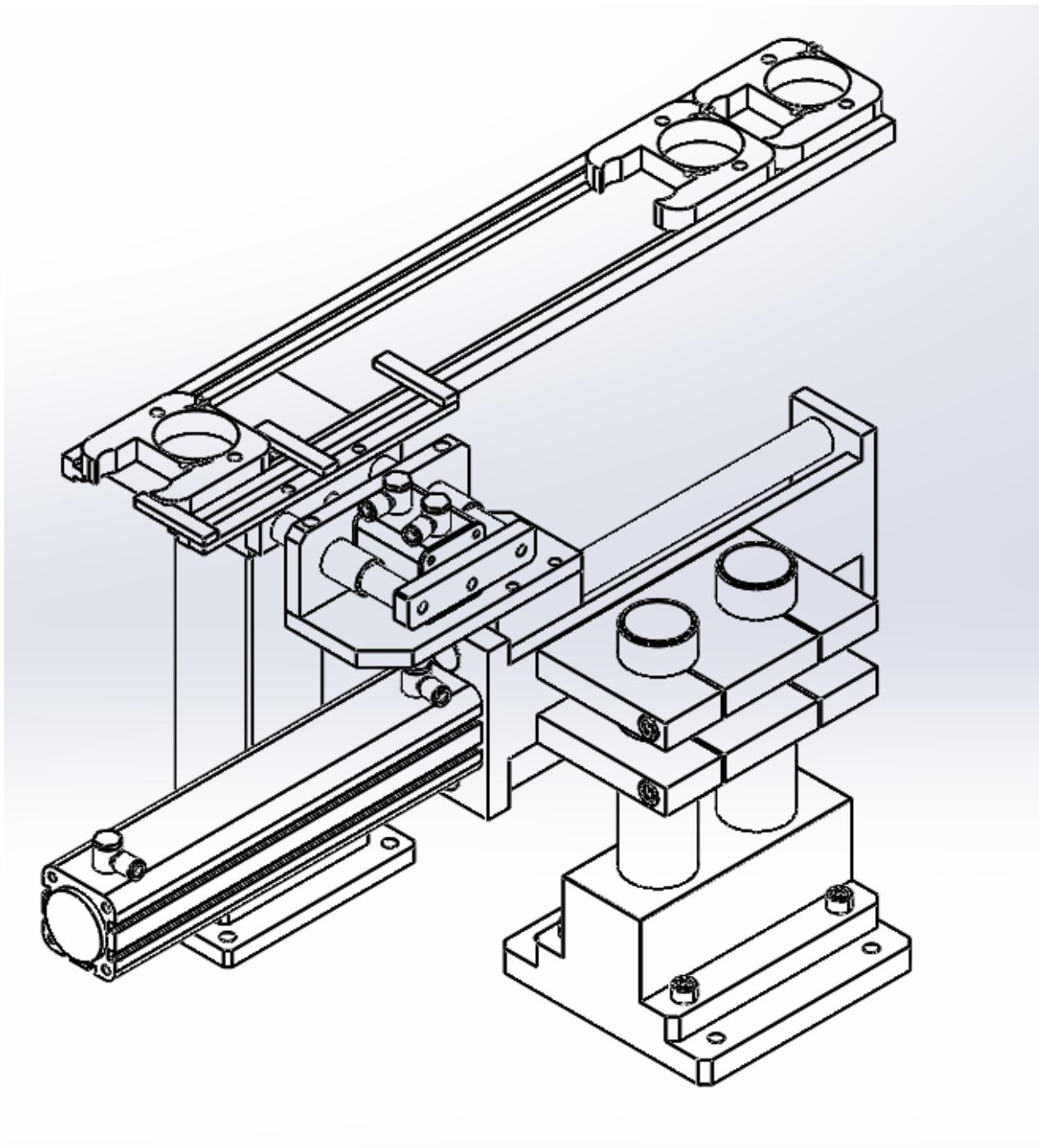
Slika 39. Pomicanje malog pneumatskog cilindra 2. Prema naprijed
