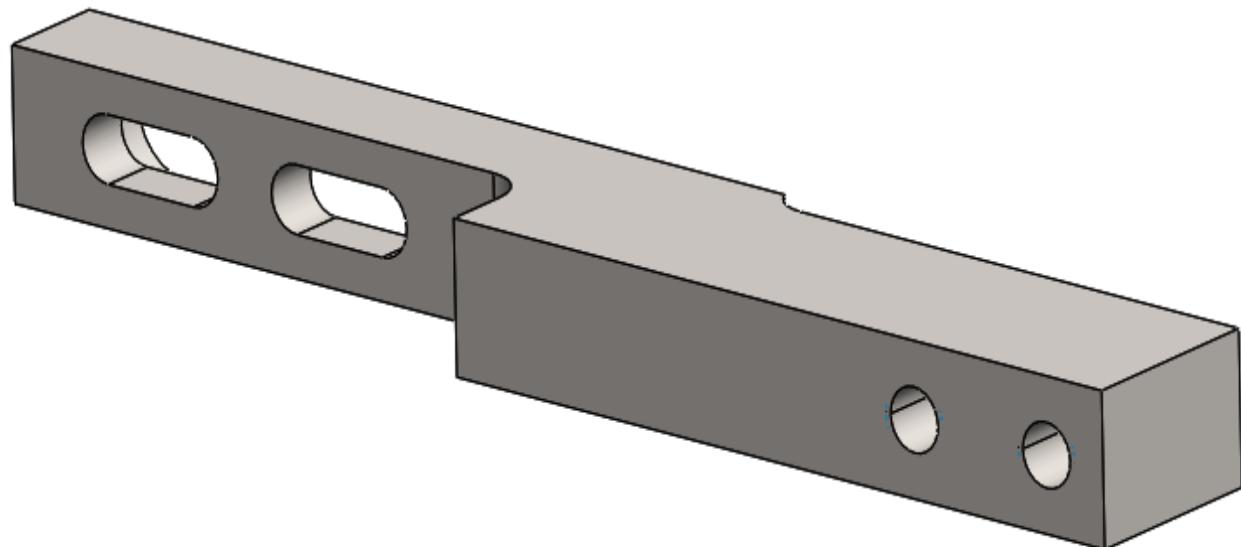
Slika 28. 3D model nosača osvjetljenja
