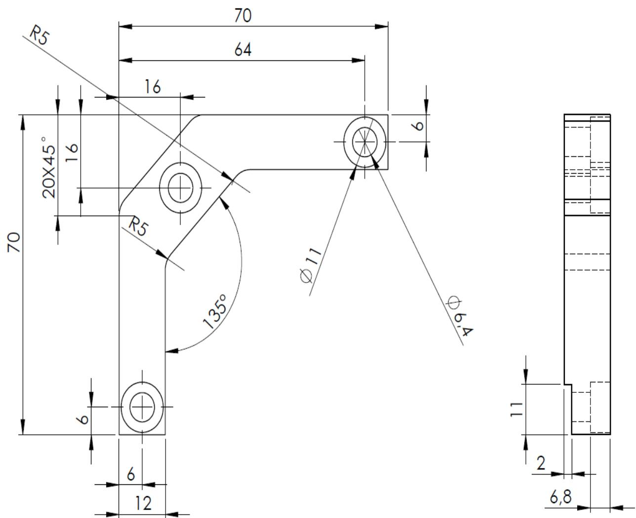
Slika 27. Skica desnog nosača svjetla
