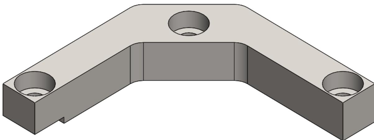
Slika 26. 3D model desnog nosača svjetla
