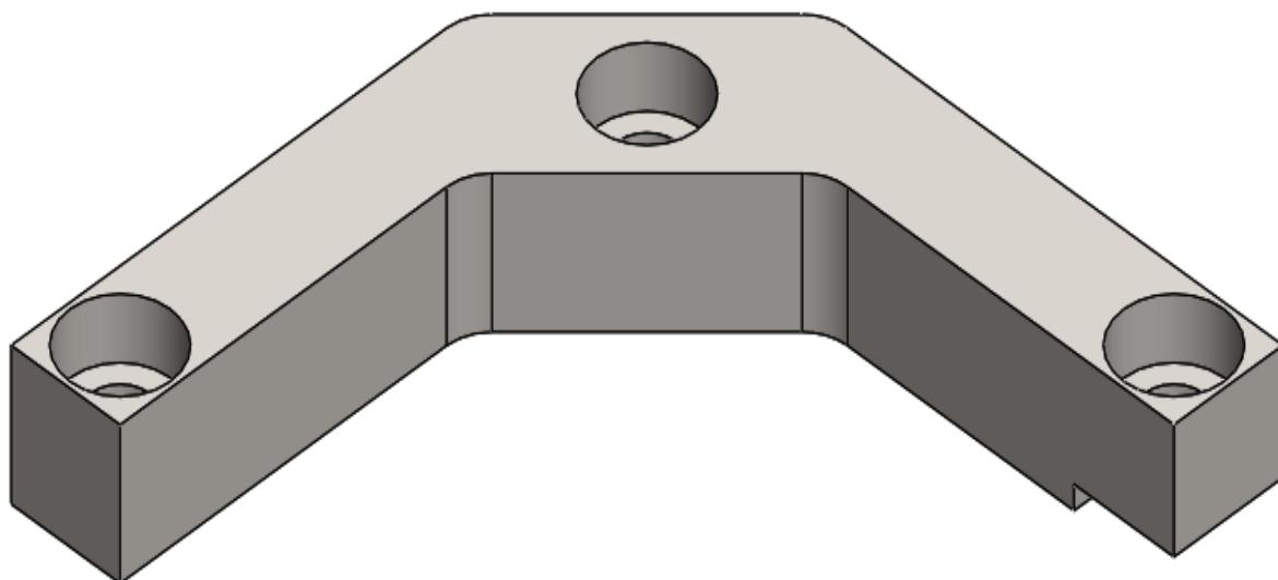
Slika 24. 3D model Lijevog nosača svjetla
