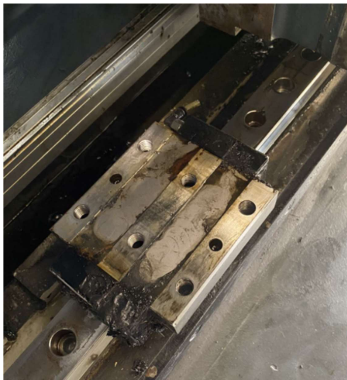
Slika 65. Odvojen pomični dio vodilice od radnog stroja
