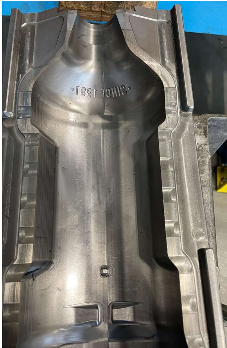
Slika 52. obradak sa vidljivim razlikama dubine u zakretima
