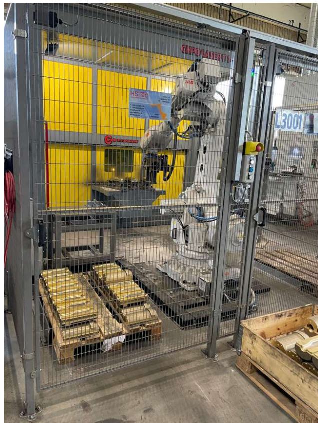
Slika 28. prikaz primjene robota za izmjenu obradka u tvrtki OMCO Croatia
