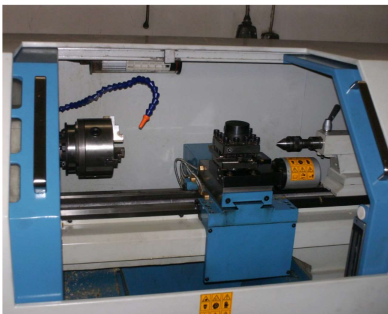
Slika 9. Vodoravna CNC tokarilica. [Metalac Krapina. "CNC tokarilica tip MT-250 CNC." Fotografija]. Dostupno na: [ https://metalac-krapina.hr/cnc-tokarilica-tip-mt-250-cnc/ ]( https://metalac-krapina.hr/cnc-tokarilica-tip-mt-250-cnc/ )
