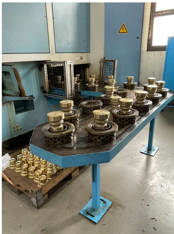
Slika 20. Sustav za automatiziranu izmjenu obradaka u tvrtki OMCO Croatia
