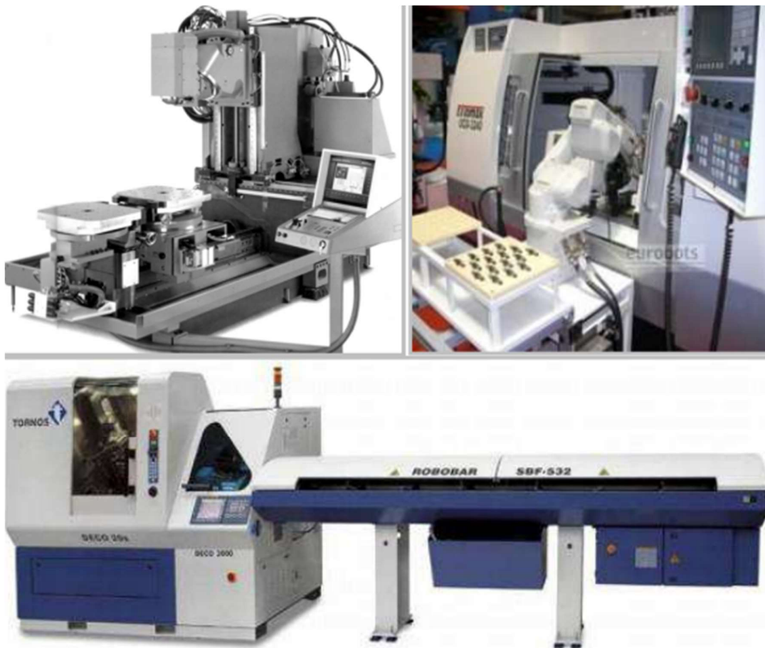
Slika 19. Sustavi za automatiziranu izmjenu obradaka [6]
