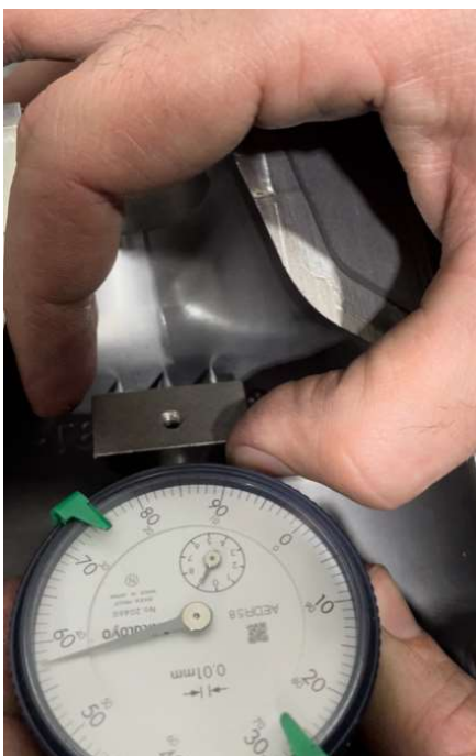
Slika 58. dubina glodanja u jednom zakretu
