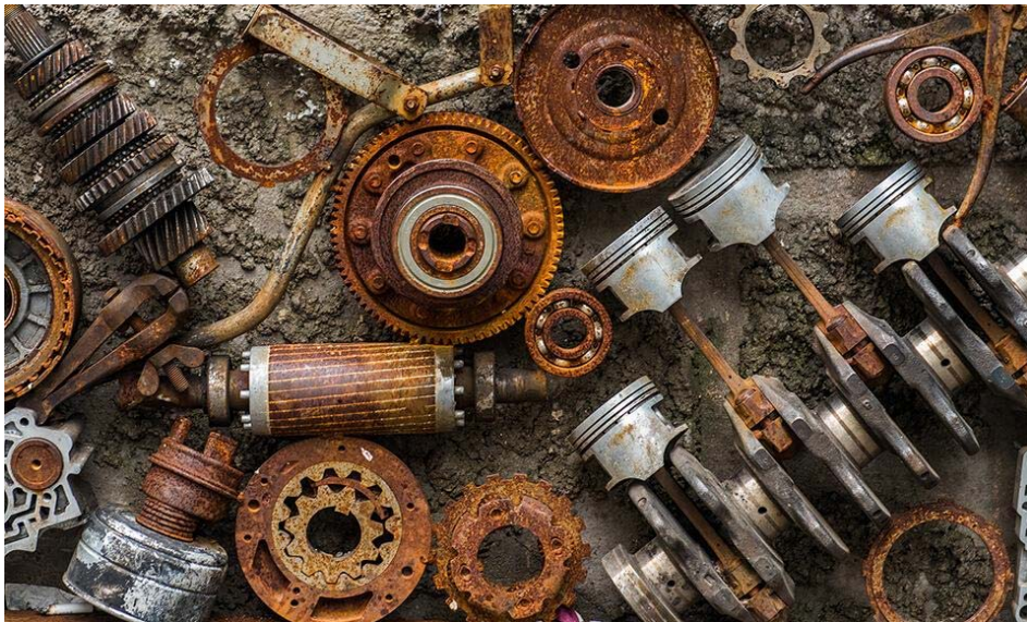
Slika 12. Primjer korozije raznih tehničkih materijala u izradcima [23]
