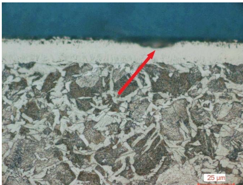
Slika 10. Deformacija nitridnog sloja vidi se na mjestu gdje se gubi fokus fotografije [22]
