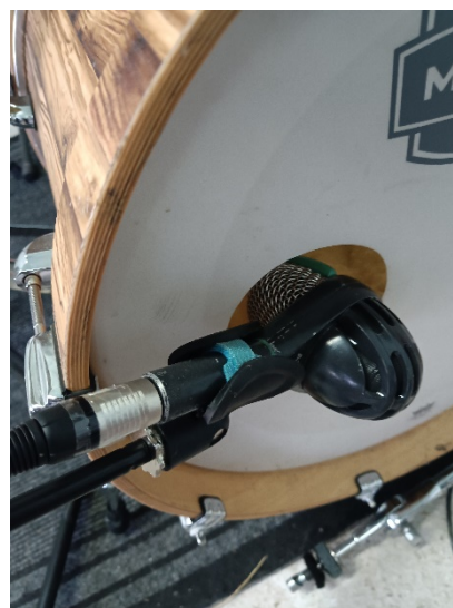
Slika 18. Pozicija mikrofona za snimanje bas bubnja
