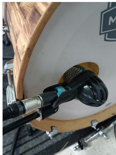
Slika 18. Pozicija mikrofona za snimanje bas bubnja
