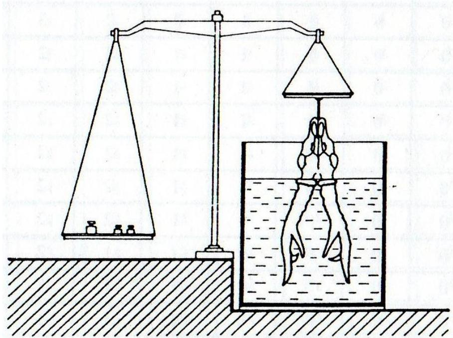
Slika 4. Hidrostatska vaga za mjerenje volumena (FRKOVIĆ, 1989)
