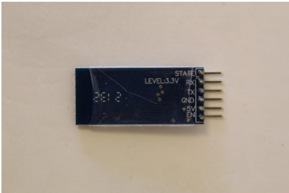
Slika 9. Predodžba prednje strane Bluetooth modula.
