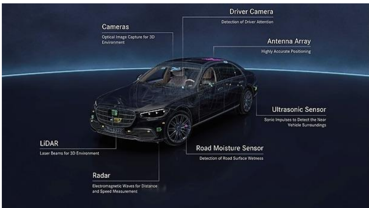
Slika 10. Senzori DrivePilot-a, Mercedes Benz S klasa, izvor [46]
