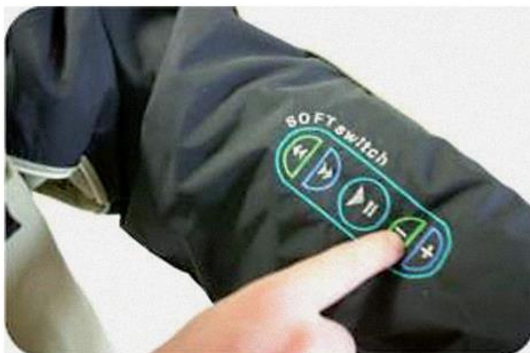
Slika 10. Vodljiva vlakna utkana u osnovni tekstilni materijal
